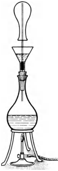
Abb. 143. Vorrichtung zum Ausdämpfen von Glas nach A b e g g.
