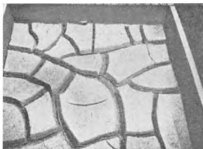
Abb. 107. Rißbildung in plastischem Ton. (Nach J. Hug.)
