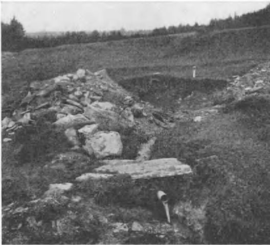
Abb. 21. Quellmessung mittels Ablaufrohr. (Aufnahme von Huber.)
