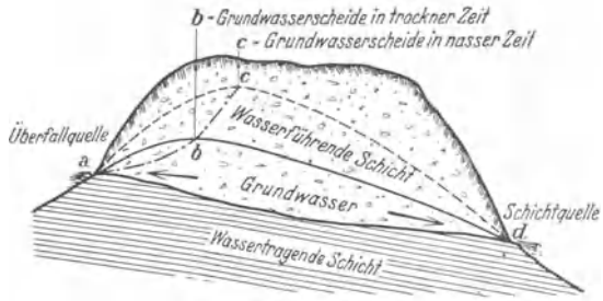
Abb. 55. Überlauf- und Schichtquelle, paarweise auftretend. (Nach Holler-Reuter.)
