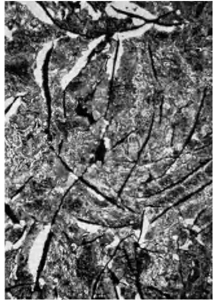
Abb. 139/1. Schliffbilder von Grauguß. Gefügeverfeinerung in der Randzone deutlich erkennbar.
