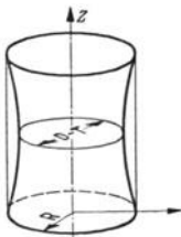
Abb. 152/2. Ausnutzung des Toleranzfeldes durch eine Hyperboloidform.
