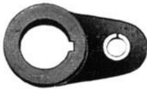
Abb. 106/3. Einspannbuchse als Verschleißteil an einem Bremsnocken.
