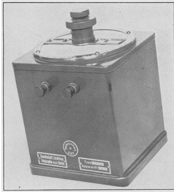
Abb. 92. Spritzgußkondensator (Gesellschaft für drahtlose Telegraphie, Berlin). \frac{1}{3} wirkl. Größe.
