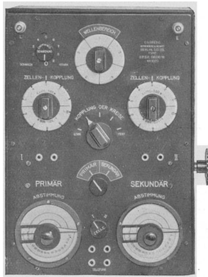
Abb. 398. Gerät für Primär- und Sekundärempfang. (C. Lorenz A.-G. Berlin-Tempelhof.) Größe: 280 \times 209 \times 360 mm.
