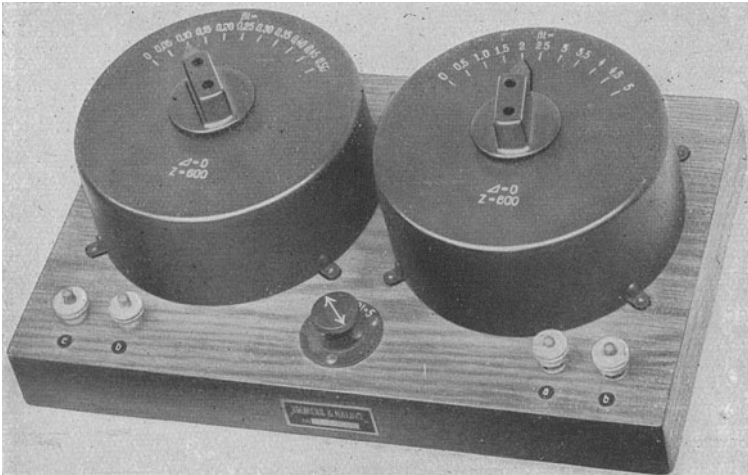
Abb. 386. Künstliche Leitung für Verstärkungsmessungen (Siemens & Halske, Berlin-Siemensstadt).
