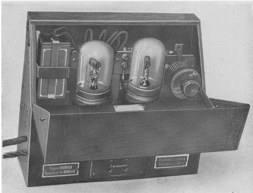
Abb. 379. Zweiröhrenverstärker. (Gesellschaft für drahtlose Telegraphie, Berlin.) Verstärkung 500fach. Größe: 230 × 200 × 90 mm.
