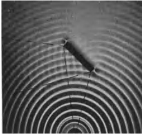
Abb. 380. Reflexion von Kreiswellen an einem Spiegel.
