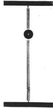
Abb. 92. Herstellung von Lissajous-Schwingungen mit Hilfe elastischer Kräfte.
