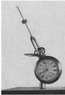
Abb. 356. Resonanz zwischen Uhrgehäuse und Unruhe.
