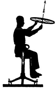
Abb. 139. Zur Erhaltung des Drehimpulses. (Bei kleinen Beschleunigungen wird man durch Reibung gestört.)
