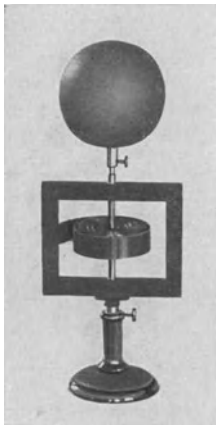
Abb. 126. Kleine Drillachse, vertikal gestellt, mit aufgesetzter Kugel. Diese Drillachse benutzt die Biegeelastizität einer Schneckenfeder. Ihr Richtmoment D^* = 0,0056 \frac{\text{kg-Kraftmeter}}{\text{Einheitswinkel}} = 0,055 \frac{\text{Großdynmeter}}{\text{Einheitswinkel}} .
