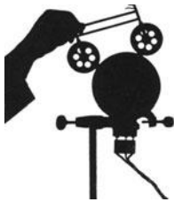
Abb. 160. Ein Fahrradmodell wird durch Anpressen an eine Scheibe auf der Achse eines Elektromotors in Gang gesetzt.
