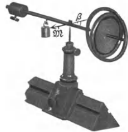
Abb. 157. Kippung eines ruhenden Kreisels unter der Einwirkung eines Drehmomentes.
