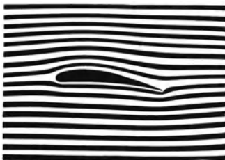
Abb. 271. Zirkulationsfreie Potentialströmung um einen Flügel. Modellversuch.
