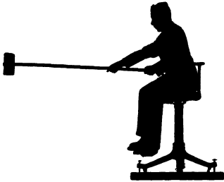
Abb. 140. Mit Hilfe eines langen Holzhammers lassen sich Drehimpulse mit verschiedenen Achsenrichtungen erzeugen.
