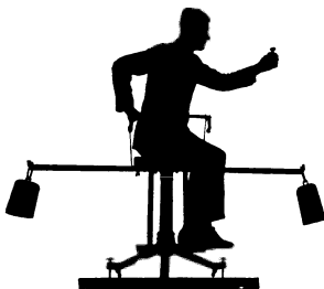
Abb. 182. Ein Drehstuhl mit hohem Trägheitsmoment zur Vorführung von Corioliskräften. Die hier gezeichneten Zusatzmassen benutzt man zweckmäßig auch bei den in den Abb. 174, 176, 178, 180 dargestellten Versuchen.
