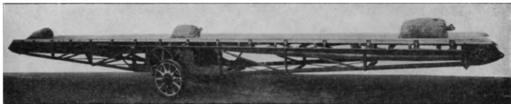
Abb. 235. Fahrbares Gurtförderband für Sackförderung (Amme, Giesecke).
