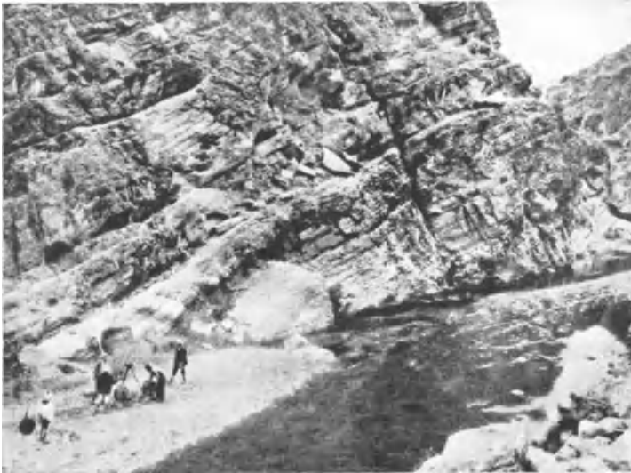
Abb. 209. Tiefentastungen im Gelände der Fom-el-Guerza-Talsperre (Algerien). (Nach R. M. Mailliet).
