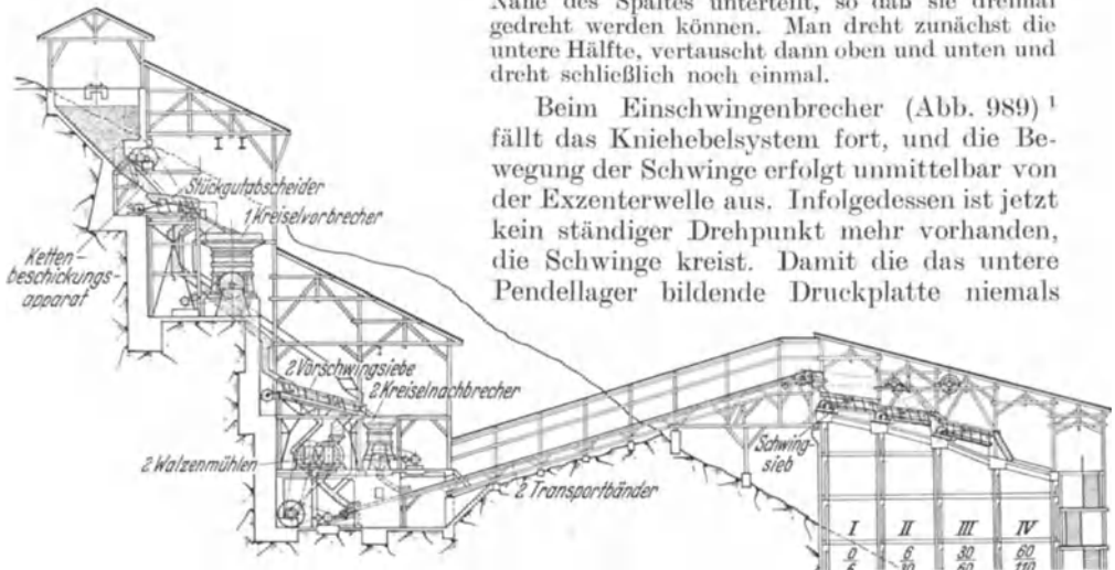
Abb. 990. Brech- und Mahlanlage für die Navia-Staumauer (Spanien). Entwurf Humboldt.
