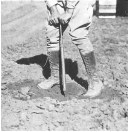
Abb. 326. Nadelprobe auf der gewalzten Schüttung. (Lichtbild von Proctor, Los Angeles.)
