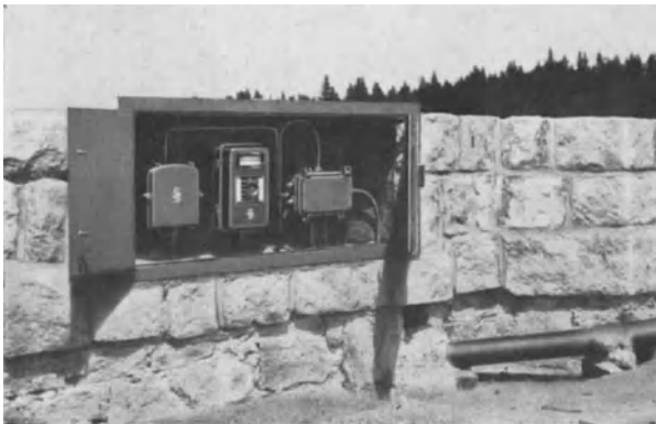
Abb. 1104. Meßschrank für die Temperaturmessungen.
