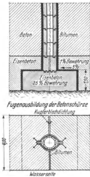
Abb. 250. Bou-Hanifia-Staudamm. Einzelheiten der Dichtungsschürze.
