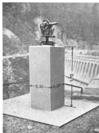
Abb. 1128. Beobachtungspfeiler der Wäggi-Staumauer. (Nach W. Lang.)
