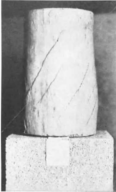
Abb. 391a. Fließlinien bei Lehm (nach Entfernen der Gummihaut); Prüfkörper d = 7 cm, h = 11 cm.
