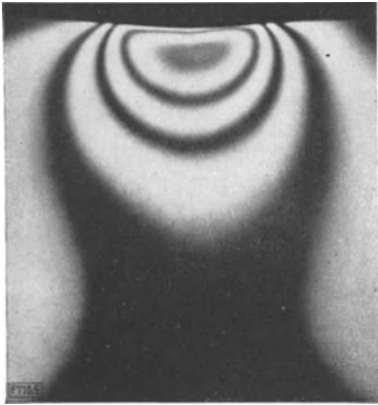
Abb. 1184. Kugeldruckversuch von G. Oppel. Farbgleichen in Scheibchen 3.
