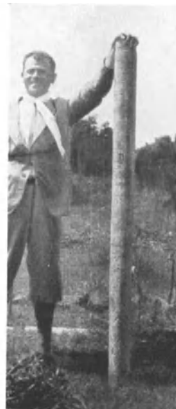
Abb. 180. Bohrkern (Stahlschrot) aus unversetztem massiven Melafyr. 1 = durch Kalkspat verheiliter Sprung. (Rio Negro, Uruguay. Ludin.)
