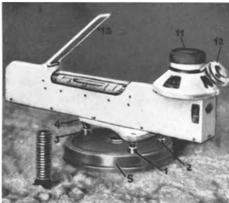
Abb. 1133. Setzklinometer nach Huggenberger.
