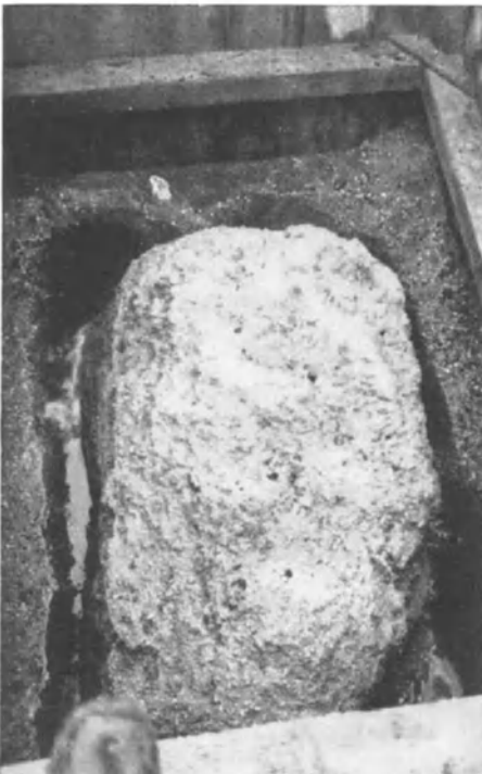
Abb. 239. Malapane-Staudamm. Chemisch verfestigter Kies, Spritzrohrabstand 1 m.
