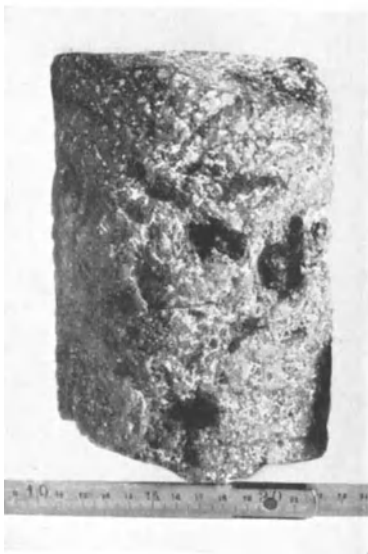
Abb. 179. Bohrkern aus leicht verändertem Melafyr einer Randschicht mit Gasblasen. (Rio Negro, Uruguay. Ludin.)
