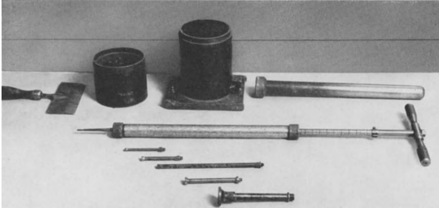
Abb. 330. Prüfgeräte (Nadelversuch und Stampfgerät). (Lichtbild von Proctor, Los Angeles.)
