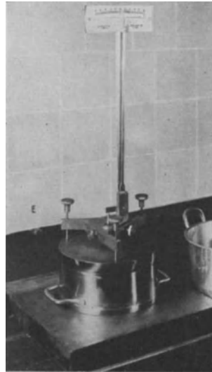
Abb. 12. Sphärometer zur Bestimmung der Topfbodendurchbiegung.
