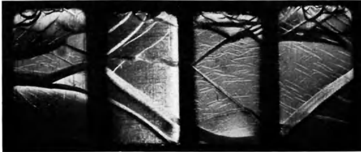
Abb. 34. Fließfiguren. Die 4 Seitenflächen eines gedruckten Eisenkörpers. Druckrichtung von oben nach unten.
