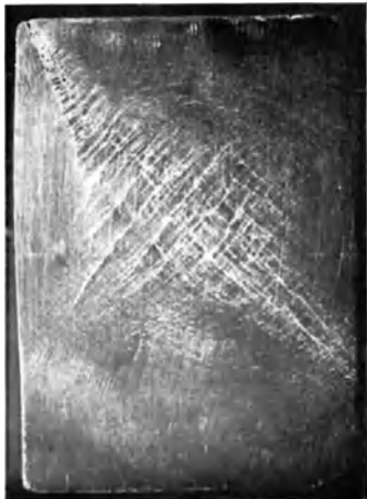
Abb. 39. Gleitlinien auf der Seitenfläche eines gedrückten Prismas aus Paraffin.
