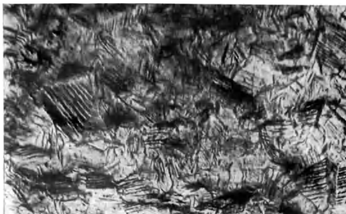
Abb. 18. Streifungen im Korn von plastisch verformtem Kupfer. Vergrößerung 100fach.
