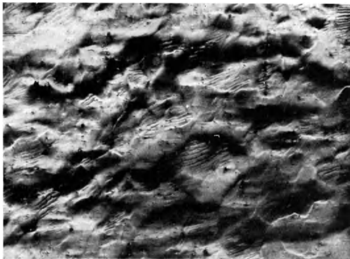
Abb. 36. Weiches Eisen. Streifungen in den Körnern innerhalb eines Fließstreifens. 70fach vergrößert.
