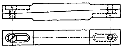
Abb 77. Verstellbare Lappeleiste für Rachenlehren
