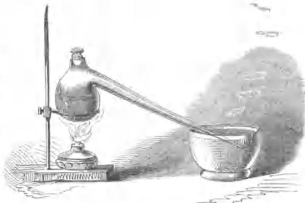
Fig. 312. Entwicklung von Phosphorwasserstoff.
