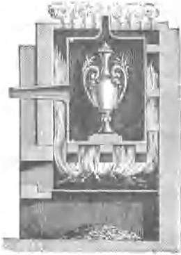
Fig. 230. Einbrennen der Farben in Muffeln.
