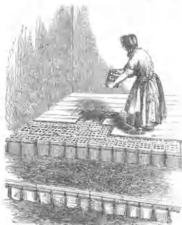
Fig. 348. Holländische Methode der Bleiweißfabrikation.
