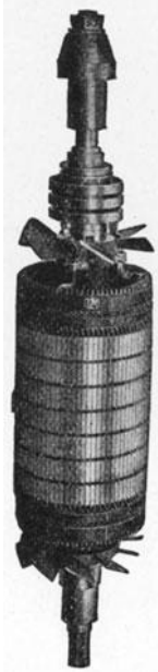
Fig. 333. Rotor mit Kühlung durch Windflügel der AEG.
