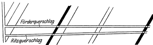
Fig. 25. Förder- und Ritzquerschlag. (K. Kegel.)
