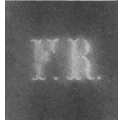
Abb. 185. Ein mit einer Stahlkugel als Objektiv hergestelltes Lichtbild in natürlicher Größe. Anordnung wie in Abb. 180. Das Ding ist eine Metallschablone von etwa 7 mm Höhe an Stelle der Lochblende L . Kugeldurchmesser 4 cm, a = 12 m, b = 18 m. Als Ding kann auch ein kleines, sehr kontrastreiches Diapositiv benutzt werden.
