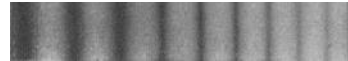
Abb. 272. Interferenzstreifen in kontinuierlichem Spektrum, hergestellt mit einer parallel zur optischen Achse geschnittenen Quarzplatte von etwa 1,1 mm Dicke.
