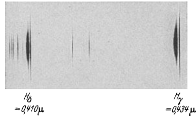
Abb. 245a. Dopplereffekt im Spektrum von H-Kanalstrahlen. Die scharfen Linien H_\gamma und H_\delta rühren von ruhenden Atomen her, die links anschließenden breiten von den mit uneinheitlicher Geschwindigkeit bewegten.
