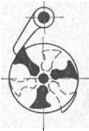
Abb. 44. Kragenscheibe zur Wurf- feuerung mit 3 Wurfweiten. Bei neueren Apparaten sind je nach der Koflänge und dem Feuerungs- material bis zu 8 Wurf- weiten vorhanden.
