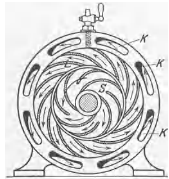
Abb. 150. Querschnitt durch eine Kreiselpumpe. S = schnell rotierendes Schleuderrad; L = feststehendes Leitrad; K = Abflußkanäle nach der Druckleitung.
