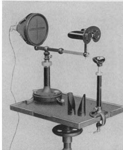
Abb. 18. Das MADDOX -Phorometer von STOCK mit eingesetzten Blendröhren für die Feinjustellung, die Blendröhre für die Naheinstellung stehen auf dem Tische. (Firma Carl Zeiß, Jena.)
