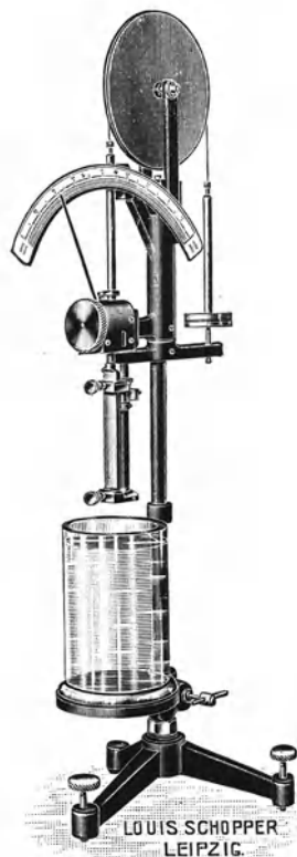
Abb. 176. Apparat von FENCHEL zur Bestimmung der Paßfähigkeit.
