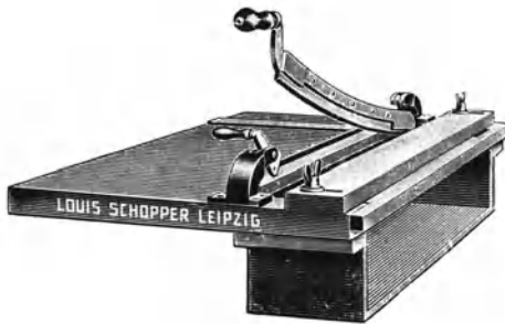
Abb. 94. Vorrichtung zum Schneiden der Streifen.
