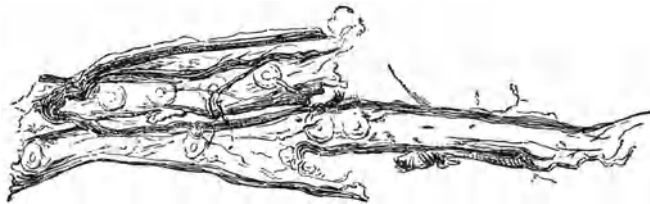
Abb. 5. Holzschliff (Fichte). Bruchstück einer Tracheide mit Hoftüpfel.
