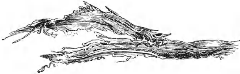
Abb. 4. Nadelholzschliff. Stark beschädigte Tracheide.
