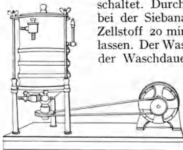
Abb. 258. „Siebanalysator“ nach SCHMIDT.
