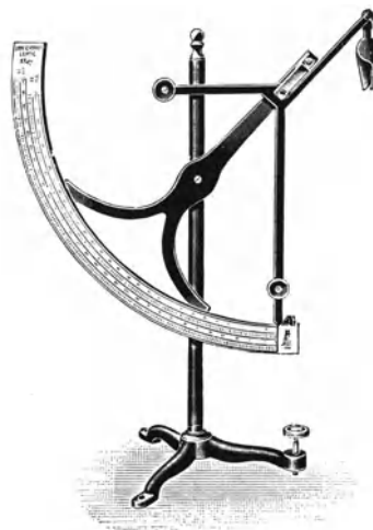
Abb. 97. Waage zur Bestimmung des Quadratmetergewichtes (Louis Schopper, Leipzig).
