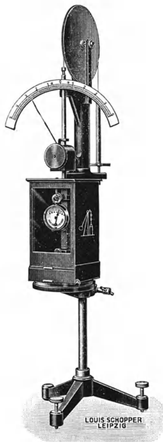
Abb. 177. Apparat von FENCHEL zur Bestimmung der Längenänderung bei Einwirkung verschiedener Luftfeuchtigkeit.
