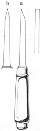
Abb. 138. Lochbeitel. a = englischer, b = deutscher Schliff.
