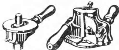
Abb. 201. Zapfenschneidhobel der Wagner.
