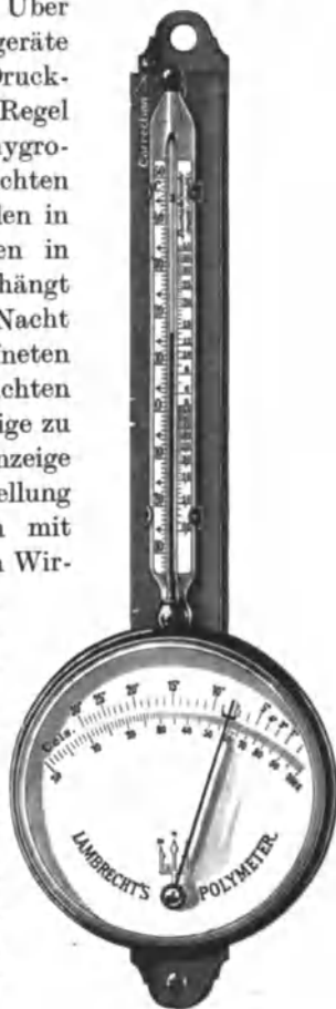
Abb. 19. Polymeter (W. Lambrecht, Göttingen).
