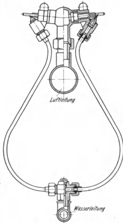
Abb. 46. Zweiseitiger Winkelzerstäuber (H. Krantz, Aachen, DRP.).
