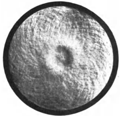
Abb 66. Schlierenbild (Fokogramm) eines mangelhaft korrigierten und polierten Objektivs (nach J. Hartmann).
