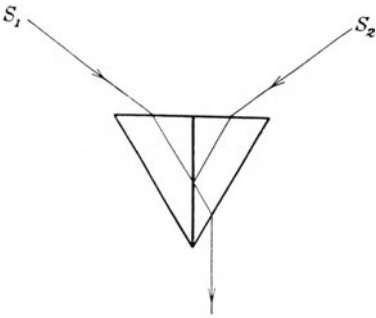
Abb. 115. Gang der Lichtstrahlen in einem Braceschen Prisma.
