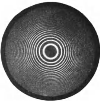
Abb. 152. Interferenzringe des grünen Quecksilberlichtes.
