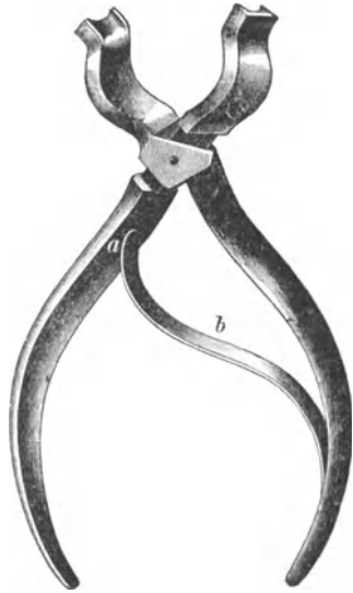
Abbildung 7. Korkzange. a b: Feder zum Auseinanderhalten.
