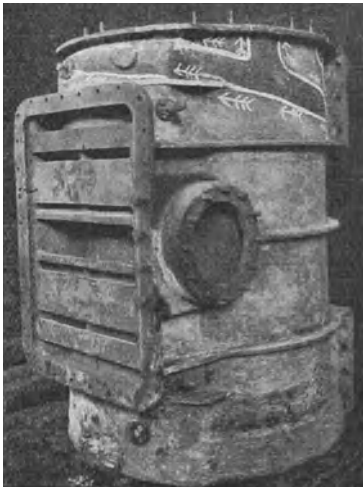
Abb. 54. Gasschweißungen an einem Dampfzylinder.
