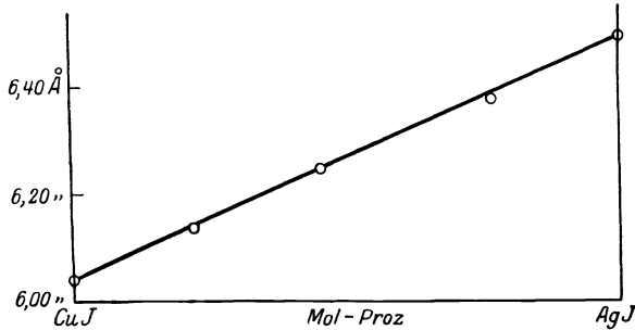
Fig. 22. Gitterkonstanten der Mischkristalle von CuJ und AgJ.
