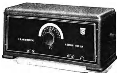
Abb. 80. Vierröhren-Neutrodyne-Einknopfempfänger (G. Schaub Apparatebau G. m. b. H., Berlin-Charlottenburg).
