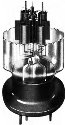
Abb. 56. Innenansicht der Polytron-Vierfachröhre nach Dr. G. O. Spanner.
