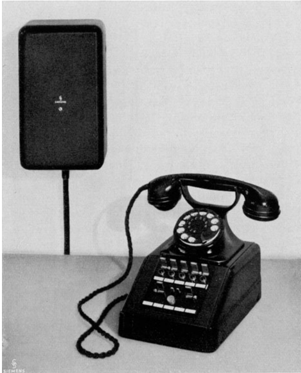
Abb. 38. Hilfsstelle für die Überwachung von fünf Verbindungsleitungen.
