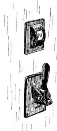
Fig. 247. Griff mit Anzeiger auf der Vorderseite der Schalttafel.
