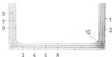
Fig. 256. Spulenkasten aus Zinkblech für 500—700 Volt isolirt.
