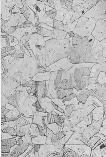
Abb. 370. Cu-Zn-Legierung, \alpha -Mischkristalle (Bauer und Hansen). \times 100 .
