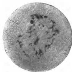
Abb. 300. Verzerrung der Seigerungszone und Ribbildung bei unweckmäßiger Warmverformung nach Sauerwald und Linke.
