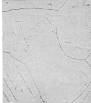
Abb. 256. Fe-C-Legierung mit 1,5% C. Natriumpikratätzung (nach Oberhoffer). × 100. Zementit + Perlit.
