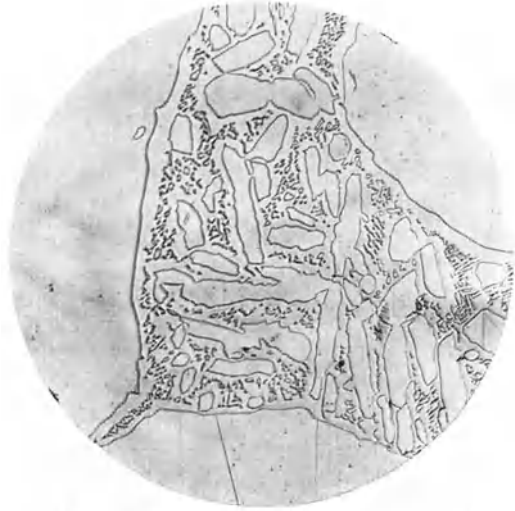
Abb. 382. Cu-Sn-Legierung mit 15% Sn (Bauer und Vollenbruck). \times 200 .
