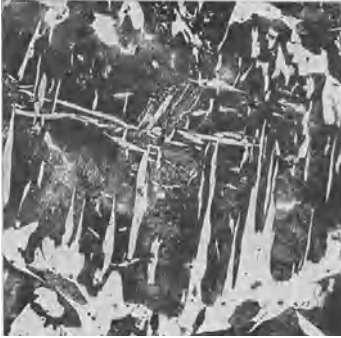
Abb. 295. Stahlrohguß mit 0,4% C nach Oberhoffer.
