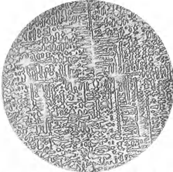
Abb. 158. Kristallseigerung im Rotguß \times 50 (Czechralski).
