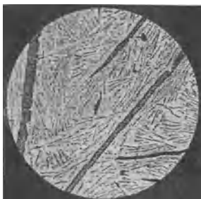
Abb. 143. Legierung mit 75,1% Sn und 24,9% Zink. \times 50 . (Nach Lorenz und Plumbridge, Z. anorg. Chem. Bd. 83, Tafel VIIIa.)
