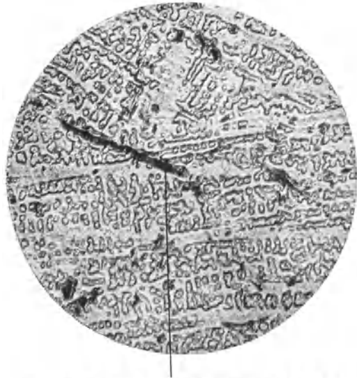
Abb. 385. Rotguß mit \text{SnO}_2 -Einschlüssen (Czoehrajski und Welter). \times 50 .
