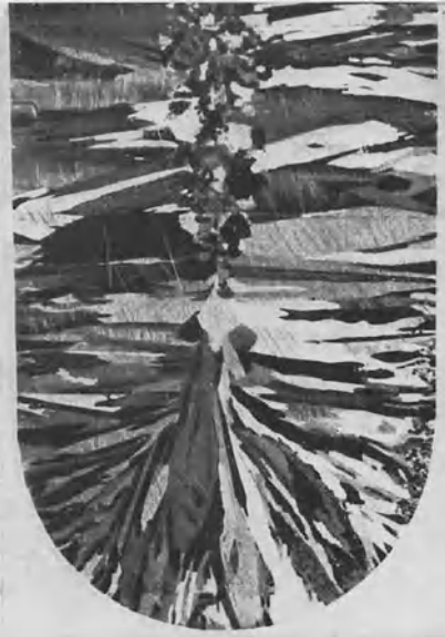
Abb. 9. Orthotropie bei Aluminiumbronze, 1:10 (nach Czochralski).
