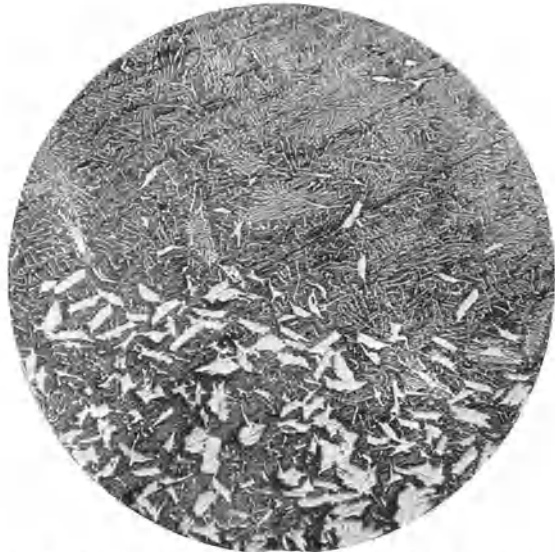
Abb. 388. Geseigertes Einheitsmetall (Czochralski-Welter). \times 50 .
