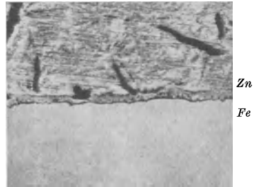
Abb. 354. El. Verzinkung nach Heidenhain-Bauer ca. \times 100 .
