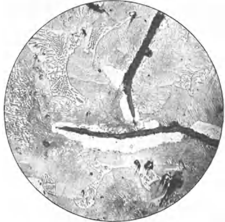
Abb. 260. Graues Gußeisen mit 3,31% ges. C, 2,81% Graphit, 1,93% Si, enthält Graphit neben Ferrit (nach Geiger). \times 350 .
