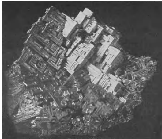
Abb. 6. Kristalle von Wismut nach unterbrochener Kristallisation (Czochralski). \times 1 .
