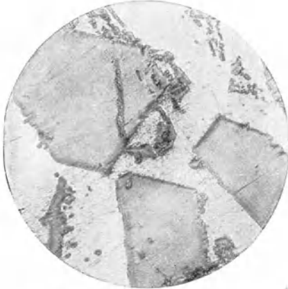
Abb. 391. Al-Si-Legierung ohne Na-Zusatz nach Czochralski. \times 175 .
