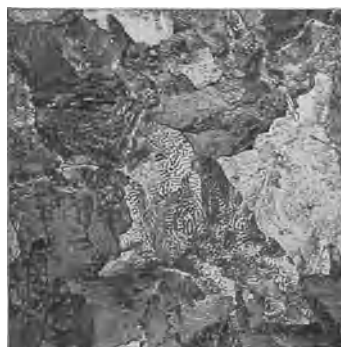
Abb. 319. Sorbit mit feinlamellarem Perlit (Oberhoffer).
