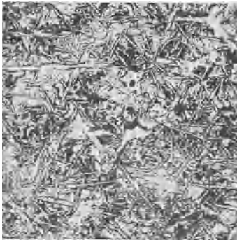
Abb. 297. Stahlguß mit 0,4% C bei 730^{\circ} geglüht nach Oberhoffer.
