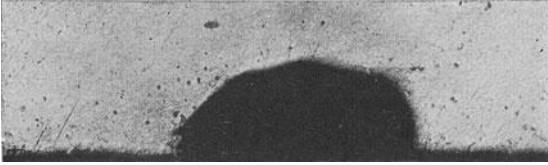
Abb. 219. Selektive Korrosion in Messing (nach v. Wurstemberger).
