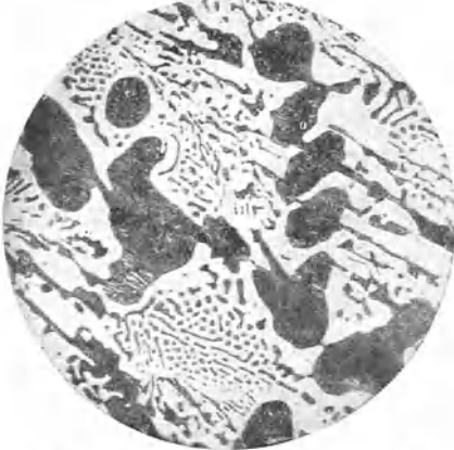
Abb. 257. Weißes Roheisen mit 3,91% C (nach Heyn). \times 275 .
