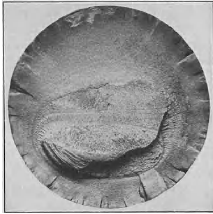
Abb. 126. Ermüdungsbruch (nach Bach-Baumann).
