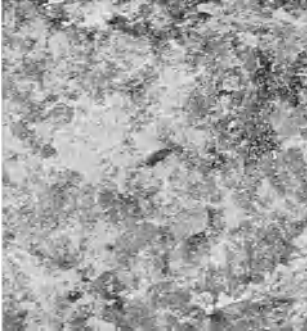
Abb. 252. Fe-C-Legierung mit 0,9% C (nach Oberhoffer). \times 100 . Perlit.
