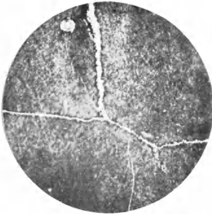
Abb. 345. W-Fe-Legierung mit 80% Fe von 1500° abgeschreckt und 20 Std. bei 700° gealtert. Brinellhärte 312 (nach Sykes). \times 1000 .
