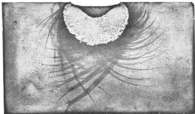
Abb. 101. Frysche Ätzung unter einem Kugeldruck (Moser, Kesselbaustoffe).
