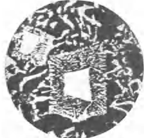
Abb. 164. Blei-Zinn-Antimonlegierung mit primärer Ausscheidung SbSn und binärem und ternärem Eutektikum \times 150 (nach Guillet, Alliages métalliques ).
