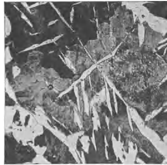
Abb. 298. Stahlguß mit 0,4% C bei 1000^{\circ} geglüht nach Oberhoffer.
