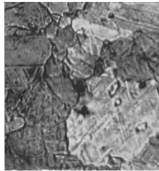
Abb. 317. Martensitähnliche Gefügeerscheinung auf einer polierten und abgeschreckten Stahlfläche (nach Sauerwald und Jackwirth).
