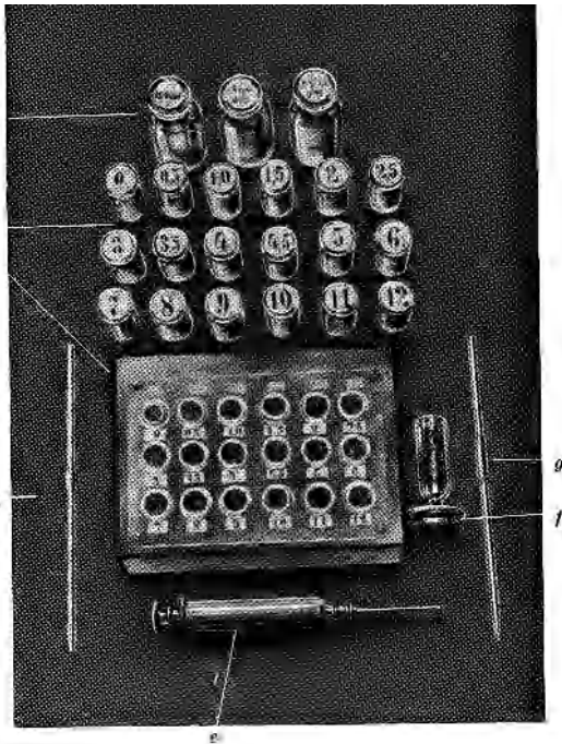
Abb. 41. Apparatur zur Bestimmung der Gerinnungswalenz. a = Fläschchen mit physiologischer Kochsalzlösung, Aq. dest. und 0,75% MgSO_4 -Lösung. b = Fläschchen mit den MgSO_4 -Lösungen steigender Konzentration. c = Glasdeckel, darunter Stativ mit den zu beschickenden Glasschälchen. d = Pipette zur Beschickung der Glasschälchen mit den MgSO_4 -Lösungen steigender Konzentration. e = LUERsche Spritze zur Blutentnahme. f = Mischtrog zur Mischung des Blutes mit der 0,75proz. MgSO_4 -Lösung. g = Pipette zur Beschickung der Glasschälchen mit der Blutmischung aus dem Mischtrog.
