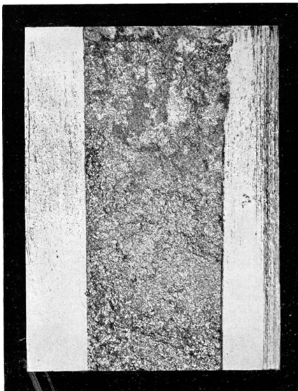
Fig. 44. Innenkohlung eines Gußblocks durch Holzkohle.
