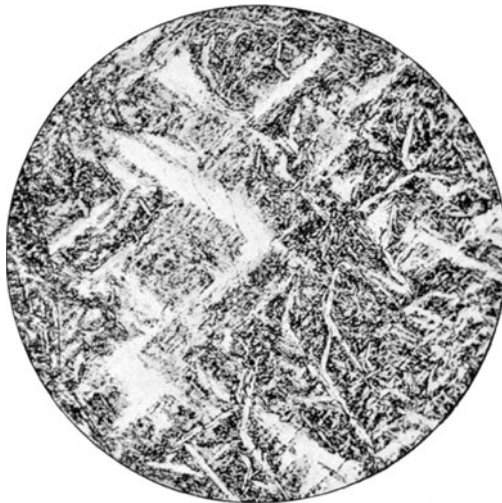
Fig. 30*. Werkzeugstahl mit 1,54% Kohlenstoff bei 1200° C in Wasser abgeschreckt. Martensit und Austenit. V = 200.
