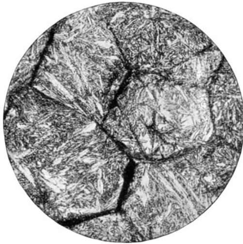
Fig. 34*. Werkzeugstahl mit 1,54% Kohlenstoff bei 1280° C in Wasser abgeschreckt. Härterisse. V = 200.
