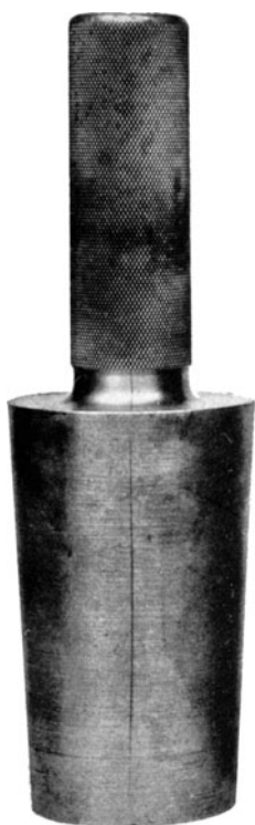
Fig. 100*, Beim Härten gerissene Kaliberbolzen (ca. \frac{1}{2} nat. Größe).
