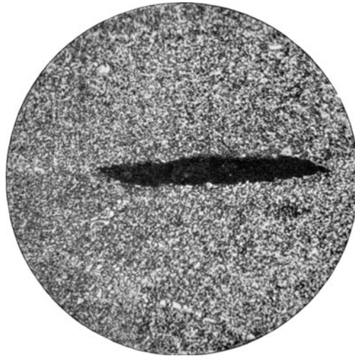
Fig. 47*. Gußblase in einem englischen Schnelldrehstahl mit 0,65% Kohlenstoff, 18,25% Wolfram, 3,65% Chrom und 0,15% Vanadium. V = 200.
