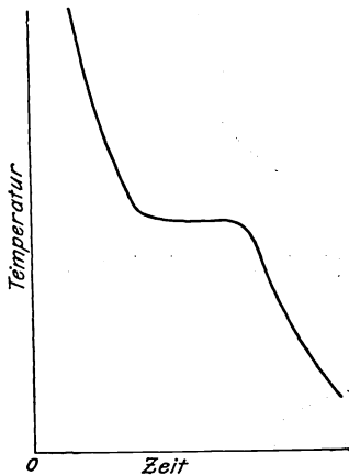
Fig. 20. Abkühlungskurve eines eutektischen Gemisches.
