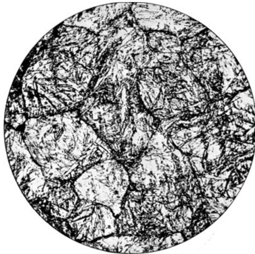
Fig. 33*. Werkzeugstahl mit 1,23% Kohlenstoff bei 1250° C in Wasser abgeschreckt. Polyederstruktur. V = 200.
