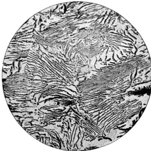
Fig. 17*. Überhitzter eutektischer Kohlenstoffstahl mit heißer Natriumpikratlösung geätzt. Der Zementit des Perlits ist dunkel gefärbt. V = 200.
