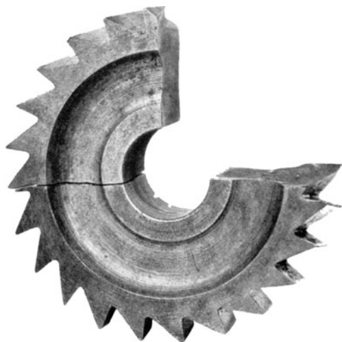
Fig. 139*. Bruchteile eines überhitzten Fräsers aus Wolframstahl. Nat. Größe.
