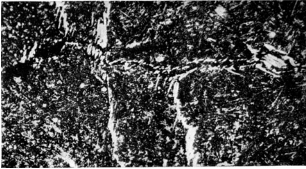
Fig. 62. Sprung in einem übereutektischen Werkzeugstahl in Richtung einer Zementitader.
