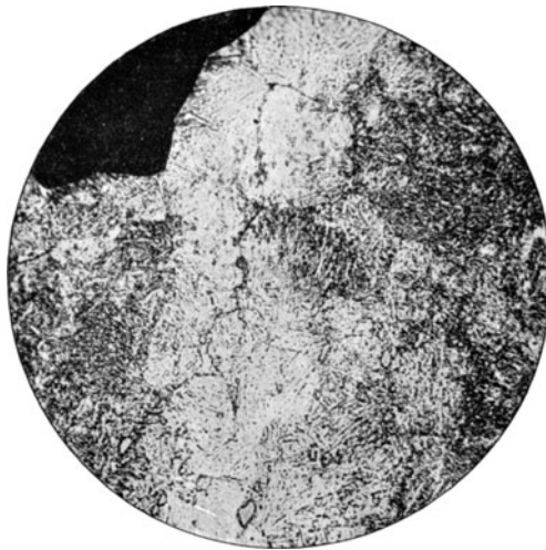
Fig. 49*. Abgesplitterte Stelle am Zahnkopfe eines Zahnes von einem im Einsatz gehärteten Zahnrade. Ein Riß verläuft in Richtung der Schlackeneinschlüsse.
