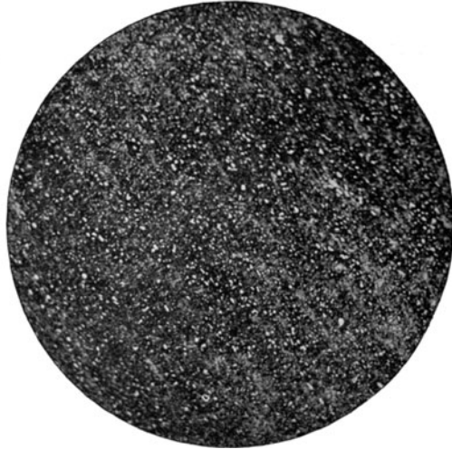
Fig. 148*. Gefüge eines Schrappers aus Schnelldrehstahl. V = 200.
