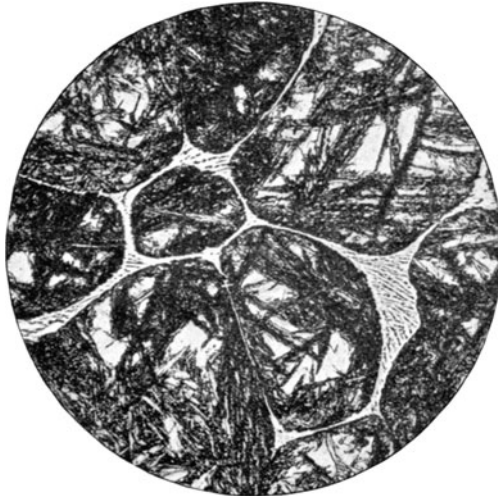
Fig. 37*. Werkzeugstahl mit 1,54% Kohlenstoff bei 1350° C in Wasser abgeschreckt. Ledeburit in Austenit-Martensit. V = 200.
