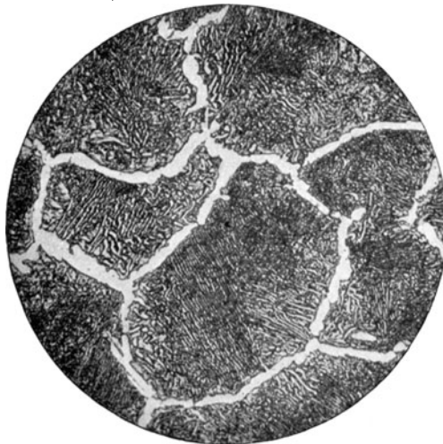
Fig. 114*. Zementstahl mit 1,30% Kohlenstoff. Perlit und Zementit. 12 Tage in Buchenholzkohle bei 1100° C zementiert. V = 200.
