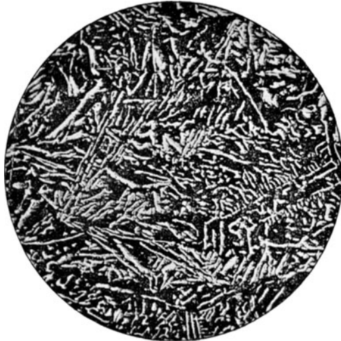
Fig. 18*. Blei-Antimon-Eutektikum. Blei (dunkel) und Antimon (hell). V = 300.
