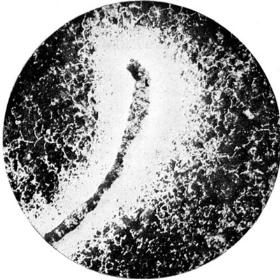
Fig. 52. Gußnaht in einem Stahlstabe. V = 12.
