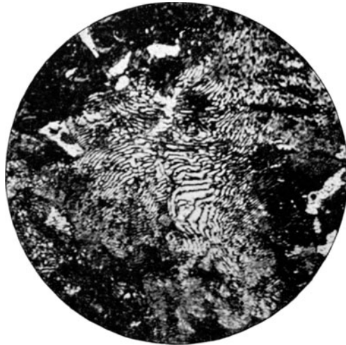
Fig. 5*. Perlit mit wenig Ferrit. V = 800.
