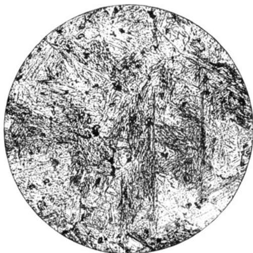
Fig. 165*. Gehärteter Elektro-Schnelldrehstahl mit 0,57% Kohlenstoff, 14,54% Wolfram und 4,55% Chrom. V = 200.
