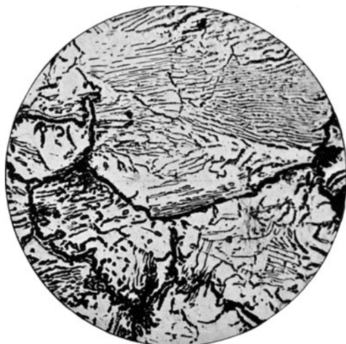
Fig. 72*. Überhitzter Kohlenstoffstahl mit 1,68% Kohlenstoff, mit heisser Natriumpikratlösung geätzt. Grober Zementit. V = 200 .
