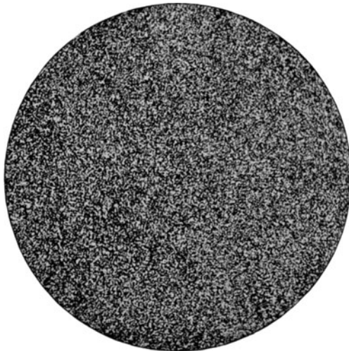
Fig. 145*. Ausgeglühter englischer Schnelldrehstahl mit 0,59% Kohlenstoff, 18,30% Wolfram und 2,38% Chrom. V = 200.
