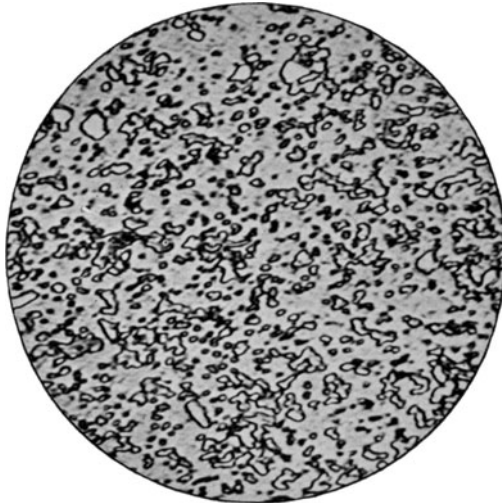
Fig. 147*. Schnelldrehstahl bei 1200° C. in Talg gehärtet. V = 600.
