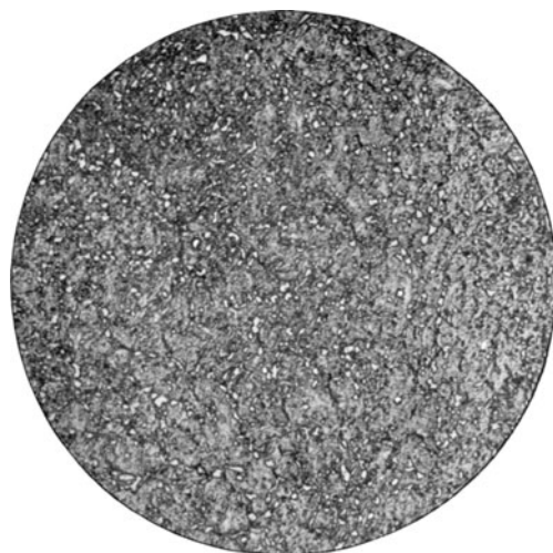
Fig. 39*. Kleingefüge der Schneide eines Drehmessers. Zementitkörner im Martensit. V = 200.
