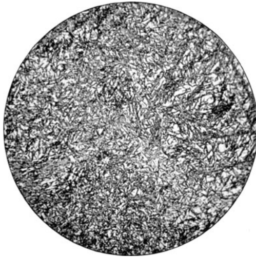
Fig. 29*. Werkzeugstahl mit 1,23% Kohlenstoff in Wasser abgeschreckt. Austenit zwischen den Martensitnadeln. V = 200.
