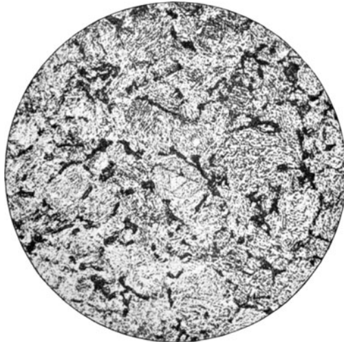
Fig. 26*. Stahl mit 0,54\% Kohlenstoff bei 740^{\circ}\text{C} in Wasser abgeschreckt. Martensit, wenig Perlit. V = 200 .
