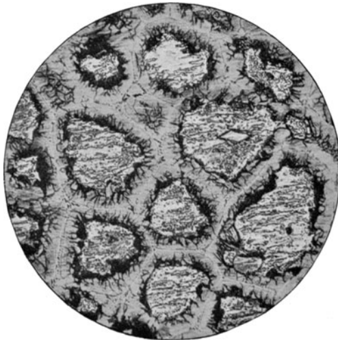
Fig. 164*. Gefüge eines an der Schneide verschmorten (verbrannten) Schneidwerkzeuges aus Schnelldrehstahl. V = 200.
