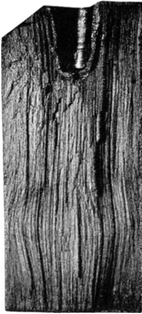
Fig. 134*. Im Einsatz gehärteter Vanadiumstahl. Bruchfläche. V = 1\frac{1}{2} .
