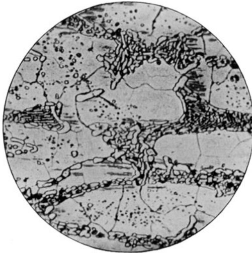
Fig. 160*. Gefüge der Schneide eines gehärteten Fräasers aus Schnelldrehstahl. V = 400.
