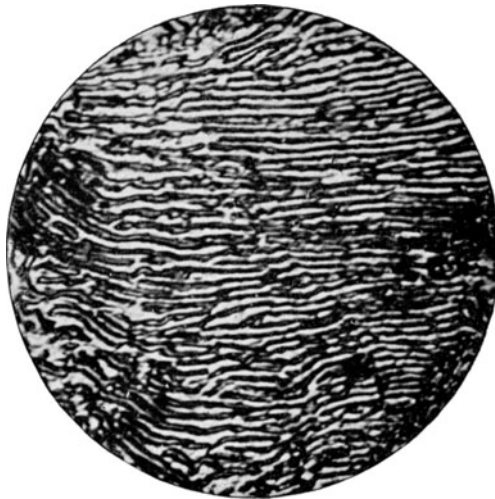
Fig. 19*. Eisen-Eisenkarbid-Eutektikum. Perlit. V = 800.
