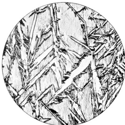
Fig. 31*. Werkzeugstahl mit 1,57% Kohlenstoff bei 1350° C in Wasser von 5° C abgeschreckt. Grobe Martensitnadeln im Austenit. V = 350.
