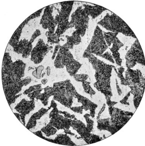
Fig. 48*. Siemens-Martinstahl mit Schlackeneinschlüssen. V = 200.
