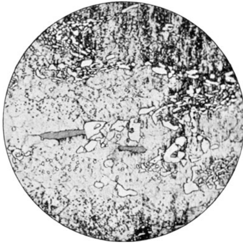
Fig. 51*. Einschlüsse in der Schneide eines gehärteten Fräsers aus Schnelldrehstahl. V = 300.
