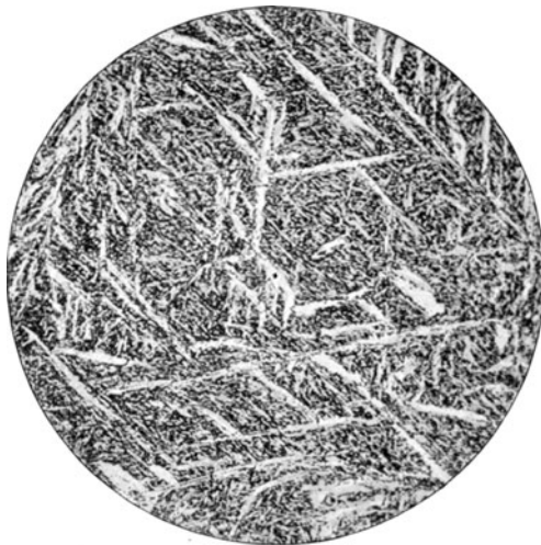
Fig. 28*. Werkzeugstahl mit 1,54% Kohlenstoff bei 1100° C in Wasser abgeschreckt. Grober Martensit. V = 200.
