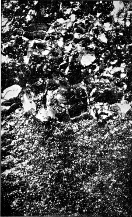
Fig. 56*. Bruchaussehen einer Herdplatte aus einem Glühofen. Obere Schicht grob, untere Schicht feinkörnig.
