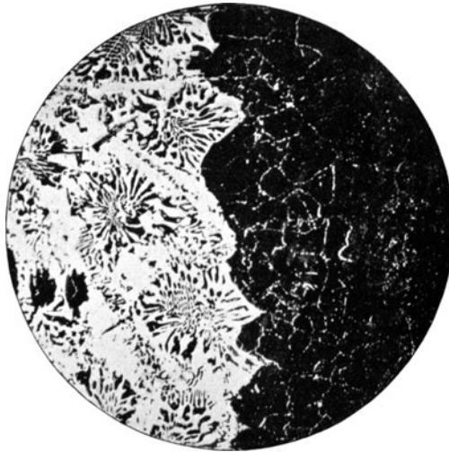
Fig. 130*. Gefüge eines im Einsatz gehärteten Stahls nach der Aufnahme von Phosphor aus dem Härtmittel. V = 100.
