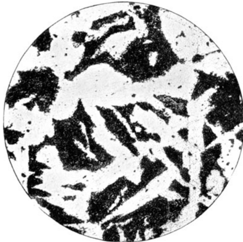
Fig. 23*. Weicher Stahl mit 0,35% Kohlenstoff. Ferrit und Perlit. V = 200.
