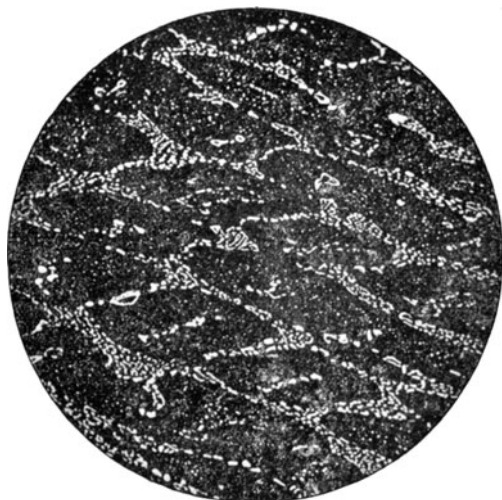
Fig. 151*. Gefüge des Zahnes eines gehärteten Zahnradfräasers aus Schnelldrehstahl. V = 200.
