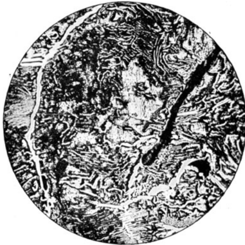
Fig. 63*. Überhitzter Stahl mit Zementitadern. Die schwarze Furche gibt an, daß Zementit ausgebröckelt ist.
