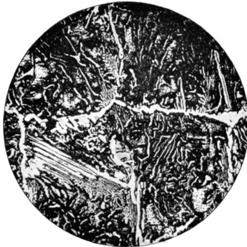
Fig. 71*. Überhitzter Kohlenstoffstahl mit 1,54% Kohlenstoff. Grober Zementit und Perlit. V = 200.
