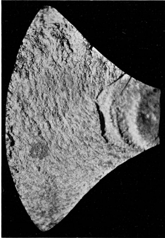
Fig. 142*. Bruchgefüge eines überhitzten Schnelldrehstahls. V = 3\frac{1}{2} .
