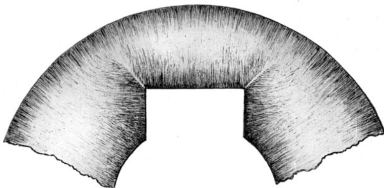
Fig. 80. Auftreten von Härtestreifungen an scharfen Ecken.
