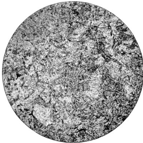
Fig. 27*. Werkzeugstahl mit 0,89% Kohlenstoff bei 820° C in Wasser abgeschreckt. Martensit. V = 200.
