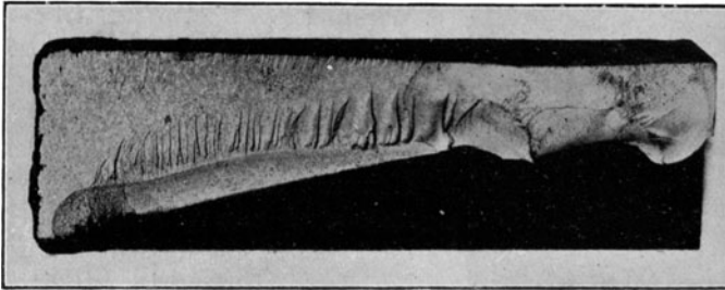
Fig. 111. Nach der Spitze zu überhitztes und regeneriertes Stahlstück mit der noch sichtbaren Wirkung des Überhitzens.
