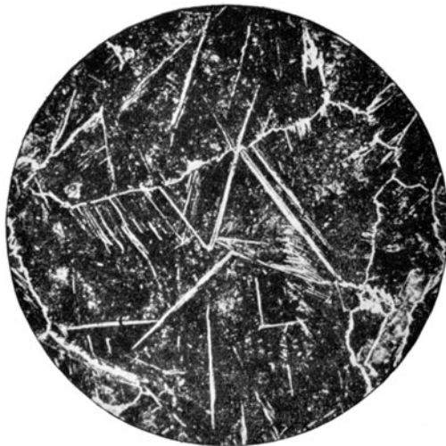
Fig. 15*. Kohlenstoffstahl mit 1,54% Kohlenstoff. Perlit und Zementit. V = 200.
