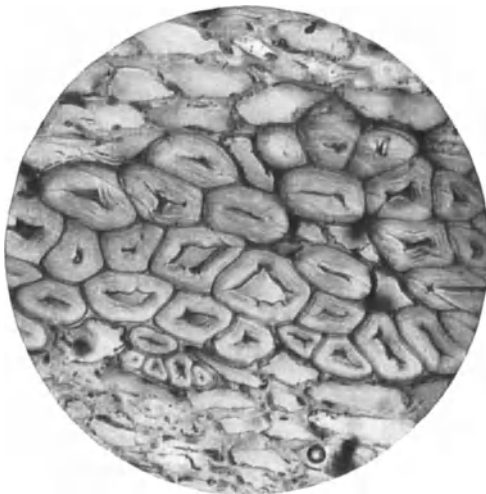
Abb. 26. Querschnitt durch ein Faserbündel des Hanfes ( Cannabis sativa ) in Chlorzinkjod. 300 mal vergr.
