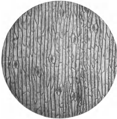
Abb. 25. Oberhaut des Flachsstengels. 100 mal vergr. Die als „Leitelement“ zur sichern Erkennung der Flachsfaser wichtige Oberhaut besteht aus auffallend langgestreckten Zellen. An vielen Stellen sind Spaltöffnungen vorhanden (etwa 3000 auf den Quadratzentimeter).
