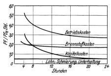
Abb. 33. Betriebskosten einer mittleren Dampfanlage in Abhängigkeit von der Betriebszeit (Normallast).
