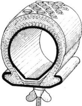
Fig. 606. Luftreifen mit Gleitschutznieten.
