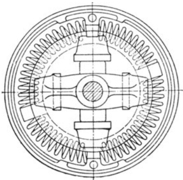
Fig. 515. Federnde Wellenkupplung der Société la Métallurgique, Brüssel.
