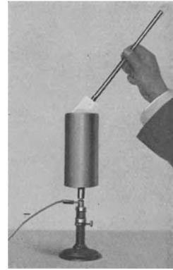
Abb. 67 a, b. Sitz der Elektrizitätsatome auf der Oberfläche eines fast allseitig geschlossenen Kastens  $\mathcal{Q}$ .
