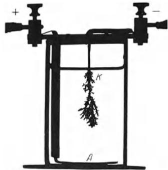
Abb. 14. Abscheidung von Bleikristallen beim Durchgang des Stromes durch wässrige Bleiazetatlösung.
