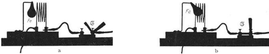
Abb. 10 a, b. Feststehende Spule und drehbar aufgehängtes weiches Eisen  $Fe$ .
