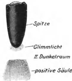
Abb. 273. Der Spitzenstrom in Zimmerluft bei mikroskopischer Beobachtung.
