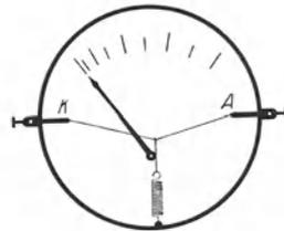
Abb. 19. Schema eines Hitzdrahtstrommessers. Man denke sich den Faden zwischen der gespannten Spiralfeder und dem Hitzdraht *KA* um die Achse des Zeigers herumgeschlungen.
