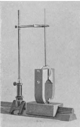
Abb. 195. Eine ringförmige „Induktionsspule“ hängt pendelnd zwischen den Polen eines auf einer Schiene verschiebbaren Hufeisenmagneten.
