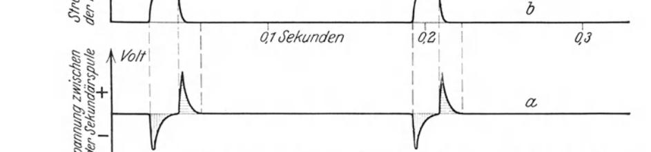
Abb. 221. Strom- und Spannungskurve eines Induktors mit kleiner Selbstinduktion der Primärschleife.
