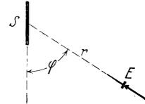
Abb. 379. Ausmessung des Dipolfeldes, radiale Komponenten des elektrischen Feldes in der Nähe des Senderdipols S.
