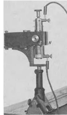
Abb. 17 b. Saitengalvanometer für Projektion. Links oberhalb von *S* das abbildende Mikroskopobjektiv.
