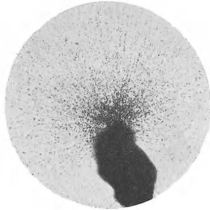
Abb. 341. Schußbahnen von  $\alpha$ -Strahlen in einer photographischen Platte. Vergrößerung etwa 500fach.
