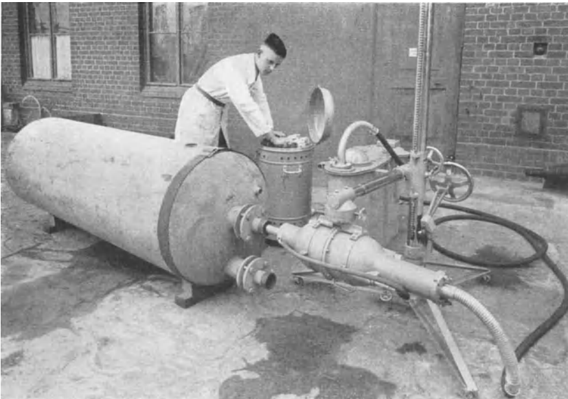
Abb. 7. Röntgendurchstrahlung einer Rundnaht mittels einer Hohlanodenröhre (Hersteller: R. Seifert u. Co., Hamburg).
