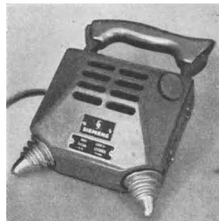
Abb. 42. Handmagnet zum Prüfen von Schweißnähten (300 A). (Hersteller: Siemens u. Halske AG., Berlin-Siemensstadt.)
