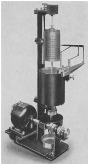
Abb. 181. HAYES-LEWIS-Viskositätsmesser von Olsen.
