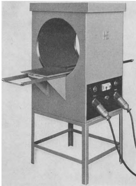
Abb. 39. Entmagnetisierungsgerät. (Hersteller: E. Heubach, Berlin-Tempelhof.)
