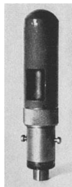
Abb. 14. Technisches Zählrohr für Wanddickenmessung (Bauart Reichs-Röntgenstelle).
