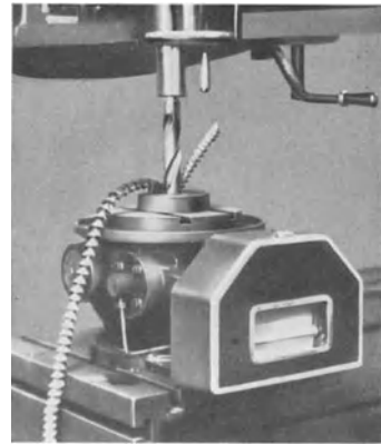
Abb. 132. Versuchsbohr Tisch von Losenhausen bis 10 t/250 mkg.
