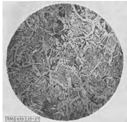
Abb. 382. Gefüge der Schweißstelle (Abbrennschweißung) ( V = 67 ).
