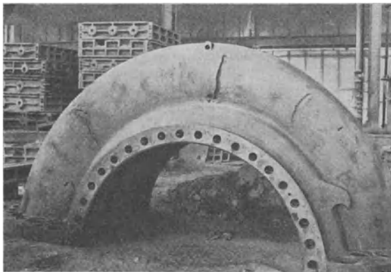
Abb. 303. Oberteil eines Spiralpumpengehäuses vor der Schweißung.
