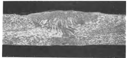
Abb. 344. Schliff einer Aluminium-Dickblechschweiße.
