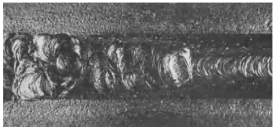
Abb. 175. Aufbau einer dreilagigen V-Schweißnaht.
