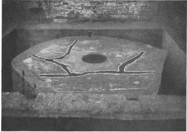
Abb. 326. Zur Warmschweißung vorbereitete Ständerplatte.
