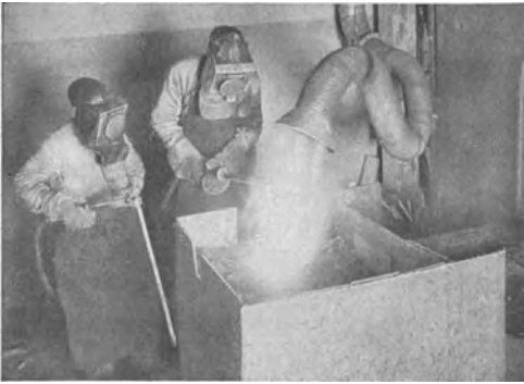
Abb. 319. Elektrische Warmschweißung eines Maschinenständers.
