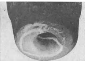
Abb. 335. Durch Schweißung ausgebesserte Hochofenwinddüse.
