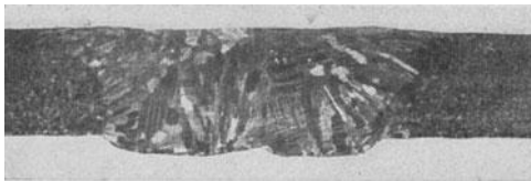
Abb. 339. Makroschliff einer elektrischen Aluminium-bronzeschweißung.
