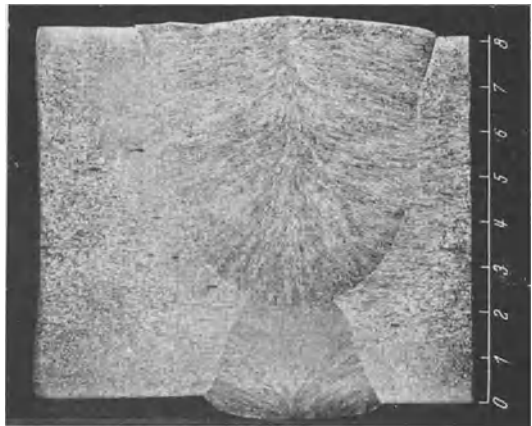
Abb. 187. Makroschliff einer Dickblechschweißnaht.
