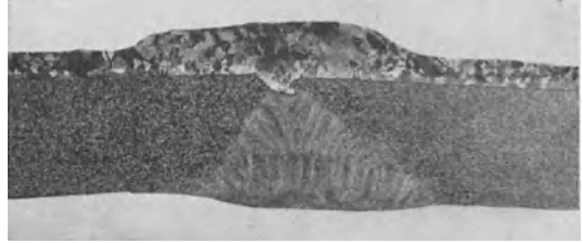
Abb. 308. Makroschliff einer Schweißnaht an kupferplattiertem Stahlblech.
