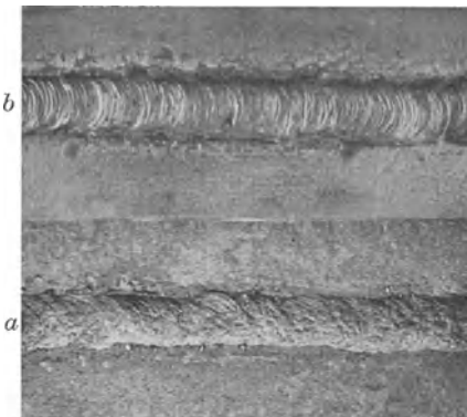
Abb. 307. Aussehen der Schweißnähte an kupferplattiertem Stahlblech.
