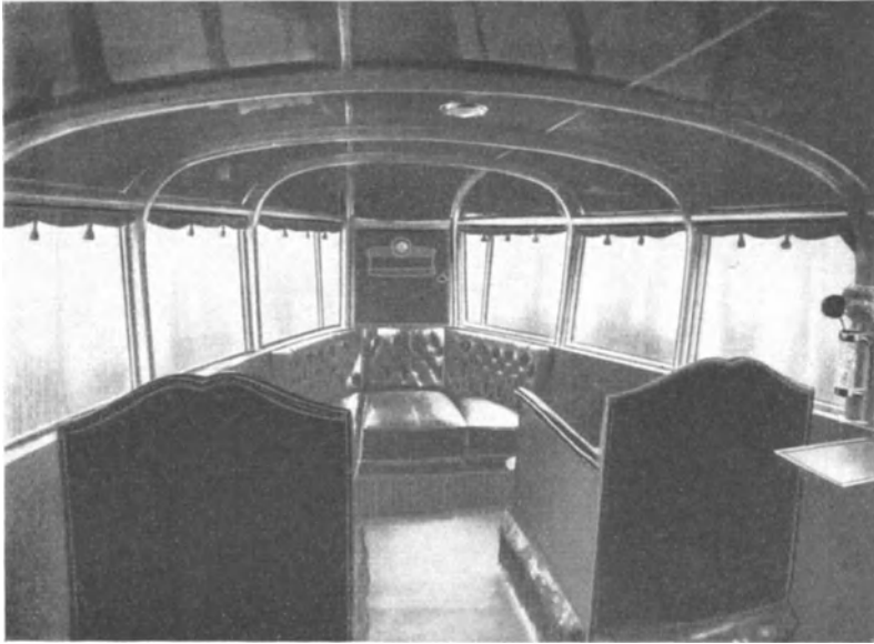
Bild 76. Fluggastraum in einem 500 PS-Flugboot (Dornier, Wal). Die Rahmenquerspannten und Längsholme treten als abgerundete Hohlrippen aus der Wandung hervor.
