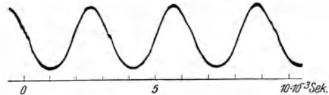
Abb. 347. Angenähert sinusförmige Schwingungskurve einer Pfeife. Aufnahme von FERD. TREDELENBURG.
