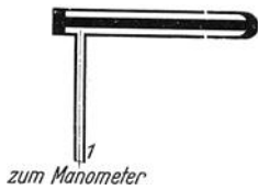
Abb. 260. Schnitt durch eine Drucksonde mit ringförmigem Schlitz zur Messung des statischen Druckes im Innern einer strömenden Flüssigkeit.
