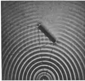
Abb. 380. Reflexion von Kreiswellen an einem Spiegel.
