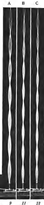
Abb. 321. Stehende Querwellen eines Gummischlauches, mit Talkum geweißt vor schwarzem Vorhang. Links ein Elektromotor mit Exzenter. Das obere Viertel des Bildes ist abgeschnitten.
