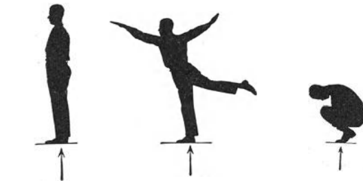
Abb. 124. Trägheitsmomente eines Menschen in drei verschiedenen Stellungen. Die Pfeile markieren die Drehachsenrichtung. a b 2,3 \text{ kg} \cdot \text{m}^2 \Theta = 1,2 \Theta = 8 0,23 \text{ Kilopond sek}^2 \cdot \text{m} \Theta = 0,12 \Theta = 0,8
