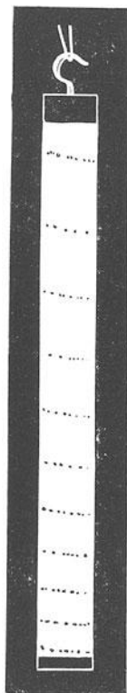
Abb. 29. Fallkörper mit Zeitmarken und deren Auswertung mit den üblichen Versuchs- und Ablesungsfehlern. Dieser Versuch soll vor allem zeigen, daß die Messung eines zweiten Differentialquotienten stets eine mißliche Sache ist.
