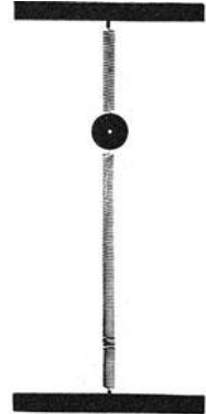
Abb. 78. Herstellung von Lissajous-Bahnen mit Hilfe elastischer Kräfte.
