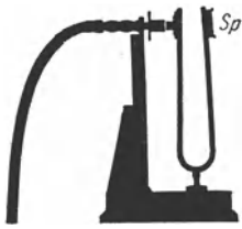
Abb. 297. Hydrodynamische Selbststeuerung einer Stimmgabel.
