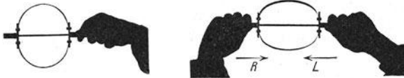
Abb. 36. Zur Verformung einer Bügelfeder. In der Mitte eine Führungsstange. Dieser einfache Apparat kann später bei Schauversuchen als ungeeichter Kraftmesser benutzt werden.
