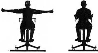
Abb. 20. Gestaltsänderungen bewirken Änderung der Drehgeschwindigkeit.
