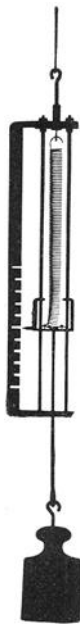
Abb. 41. Für Schattenwurf geeignete Federwaage. (Benutzt wird Verdrillungselastizität, man denke an den Grenzfall!)
