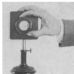
Abb. 428. Ein feines Glashaar als Bewegungsempfänger. In Wirklichkeit nur 0,028 mm dick.
