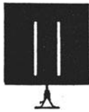
Abb. 412. Doppelspalt für das in Abb. 413 gezeigte Interferometer.
