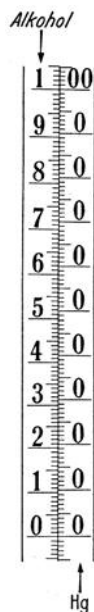
Abb. 445. Rechts die Skala eines Quecksilberthermometers mit der gleichförmigen Teilung zwischen 0 Grad und 100 Grad, links die Teilung eines mit Hilfe des Quecksilberthermometers geeichten Alkoholthermometers.
