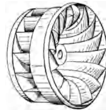
Abb. 526. Der Läufer einer Francis-Turbinen.
