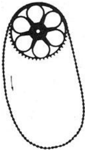
Abb. 54. Oval einer Fahrradkette vor dem Abwerfen vom Zahnrad.
