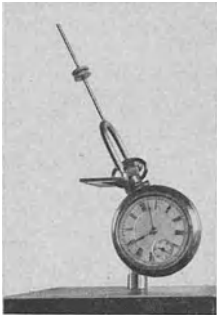
Abb. 356. Resonanz zwischen Uhrgehäuse und Unruhe.
