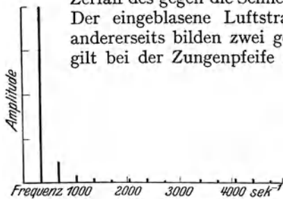
Abb. 346. Das Spektrum der in Abb. 347 dargestellten Pfeifenschwingung.
