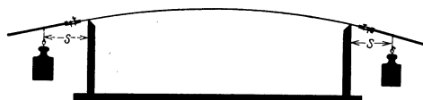
Abb. 193. Biegungsbeanspruchung eines schlanken flachen Stabes durch ein längs der ganzen Stablänge konstantes Drehmoment \mathfrak{M} . Zahlenbeispiel: Messing: d = 12 \text{ mm} ; h = 4 \text{ mm} ; J = 64 \cdot 10^{-12} \text{ m}^4 . \mathfrak{M} = 2 \text{ Kilopond} \cdot 0,15 \text{ m} = 3 \cdot 10^{-1} \text{ Kilopondmeter} . r gemessen = 2,28 \text{ m} ; daraus berechnet Dehnungszahl \alpha = 9,4 \cdot 10^{-5} \text{ mm}^2/\text{Kilopond} .
