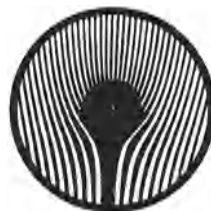
Abb. 336 a u. b. Das Zaunphänomen bei verschiedener Radgeschwindigkeit.
