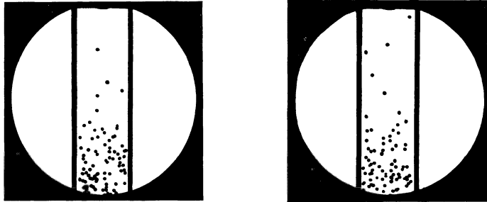
Abb. 240. Zwei Momentbilder eines Stahlkugelmodellgases zur Veranschaulichung der Barometerformel. Belichtungszeit je 8 \cdot 10^{-4} Sekunden.
