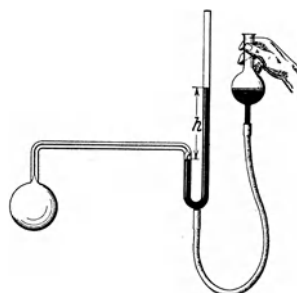
Abb. 446. Schema eines Gasthermometers. Durch Nachfüllen von Hg wird das Volumen des Gases konstant gehalten und die Höhe der Quecksilbersäule abgelesen. Sie liefert den Druck des Gases, und aus ihm berechnet man die Temperatur gemäß § 142.
