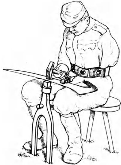
Abb. 6. Sensendengeln mit dem Bauerngürtel von Pokorny.
