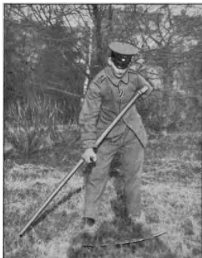
Abb. 29. Sense mit Armkrücke (Reservelazarett Offenbach a. M.).
