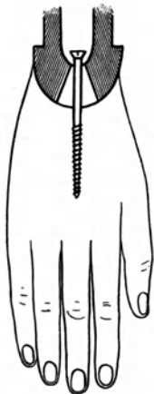
Abb. 10. Kugelhandgelenk mit Beweglichkeit bis zu einem Winkel von ca. 30°.
