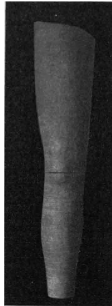
Abb. 2. Fertige Formhülse aus Vulkanfiber.
