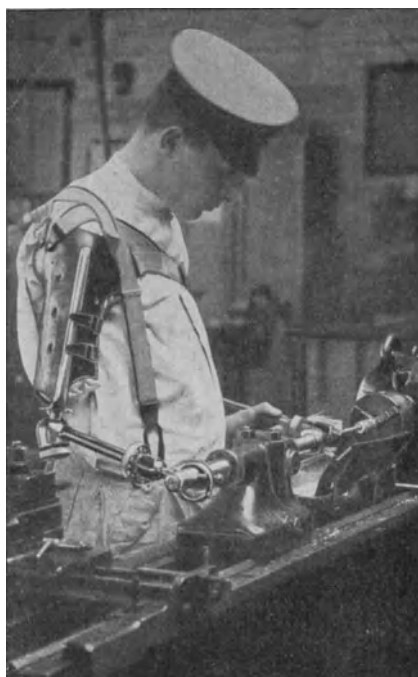
Abb. 9. Beschädigung: Rechter Oberarm amputiert. Arbeitet mit Jagenberg-Kunstarm als Mutternschneider in der Mechanischen Werkstatt der Accumulatoren-Fabrik A.-G.
