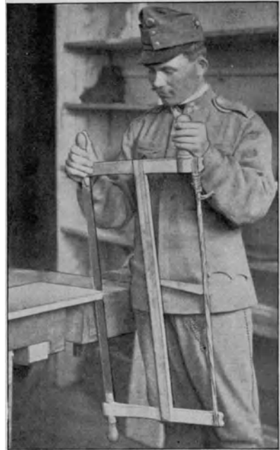
Abb. 34. Säge für Handbeschädigte (Orthopädisches Spital in Wien).
