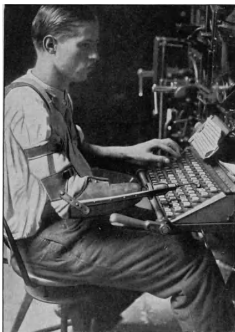
Abb. 12. Beschädigung: Verlust des rechten Unterarmes, Verlust der Sehkraft des linken Auges, Versteifung von mehreren Fingern der linken Hand. Arbeitet: als Maschinensetzer an der Lynotype in der Druckerei von Otto Elsner.
