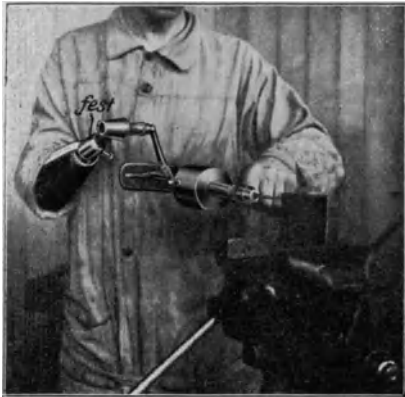
Abb. 38. Arbeiten mit Handbohrmaschine. Handgelenk festgestellt.
