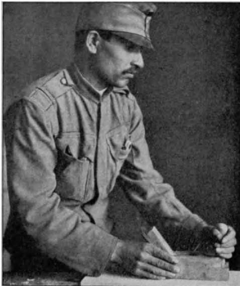
Abb. 32 und 33. Hobel für Handbeschädigte (Orthopädisches Spital in Wien).
