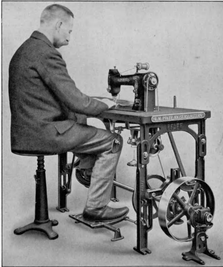
Abb. 41. Antrieb an Nähmaschinen der Nähmaschinenfabrik G. M. Pfaff.
