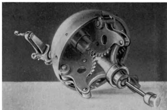
Abb. 384. Handschließgetriebe mit Selbstsperrung.
