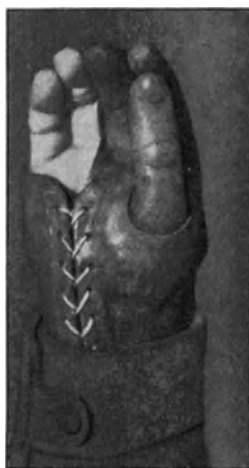
Abb. 47. Hohllederfinger von Haertel-Breslau. Zwei-Finger- und Daumen-Ersatz.
