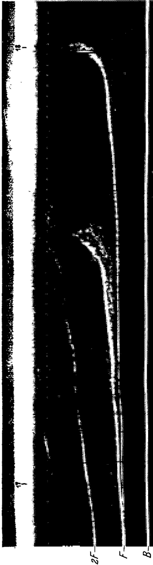
Abb. 18. Aufspaltung bei abnehmender Trägerdichte.
