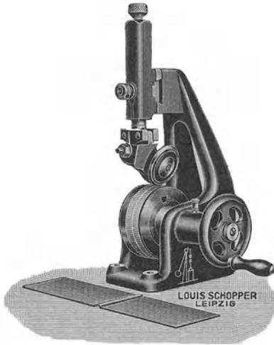
Abb. 47. Schoppers Apparatur zur Anbringung von Rillen.
