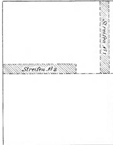
Abb. 18. Entnahme der Probestreifen.
