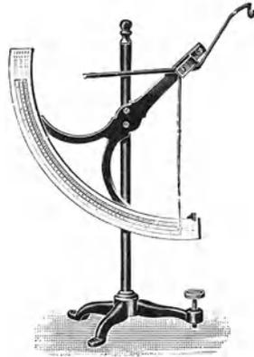
Abb. 11. Waage zur Bestimmung des Quadratmetergewichtes bei einem Handmuster.
