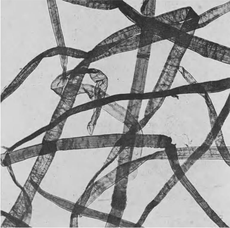
Abb. 133. Netzförmige Äderung auf Sulfitzellstofffasern.
