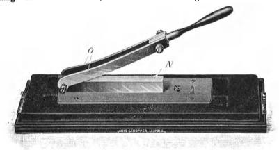
Abb. 26. Vorrichtung zum Schneiden der Versuchsstreifen für den Schnell-Papierprüfer.
