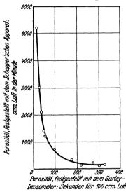
Abb. 75. Kurve von Hall für den Vergleich der mit dem Schopperschen Apparat und dem Gurley-Densometer erhaltenen Werte.
