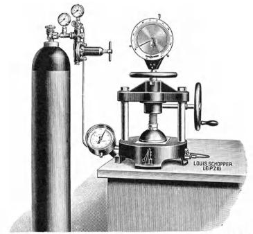
Abb. 37. Berstdruckprüfer Schopper-Dalén für Hartpappen, Preßspan usw.
