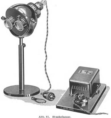
Nitralampe 8 Volt 50 HK. Die erzielte Beleuchtung beträgt etwa 4000 Lux. Unumgänglich notwendig ist die Lampe bei Glanzmessungen, bei denen paralleles Licht gebraucht wird. Für Farbtonbestimmungen dürfte jedoch zerstreutes Tageslicht bei Aufstellung des Apparates nach Norden vorzuziehen sein.
