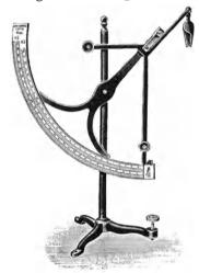
Abb. 10. Waage zur Bestimmung des Quadratmetergewichtes mit Hilfe von 5 Bogen.
