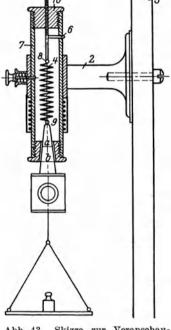
Abb. 43. Skizze zur Veranschaulichung der Prüfung der Klemmen des Schopper-Falzers.
