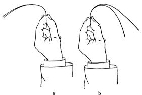
Abb. 17. Bestimmung der Längsrichtung im Papier nach Nickel.
