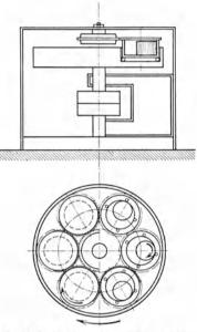
daß alle 10 Minuten eine der sechs Büchsen aus der Maschine entfernt und durch eine Leerbüchse ersetzt wird.
