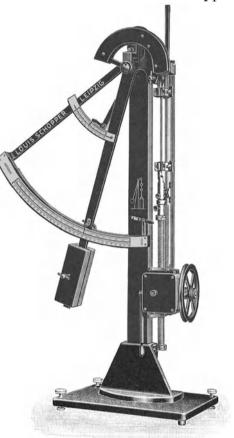
Abb. 22. Schoppers Festigkeitsprüfer für Papier mit mechanischem Antrieb.
