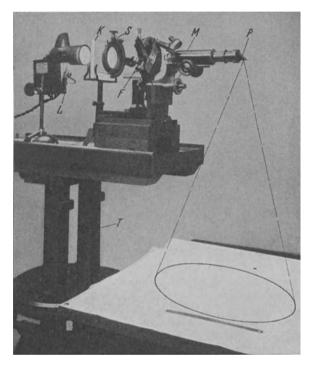
Abb. 102. Projektionseinrichtung für Fasermessungen.
