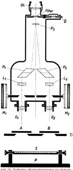
Abb. 78. Zeißsches Stufenphotometer im Schnitt.
