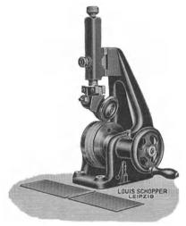
Abb. 47. Schoppers Apparat zur Anbringung von Rillen.
