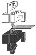
Abb. 30. Einspannklemme für Einreißversuche (Firma Schopper).
