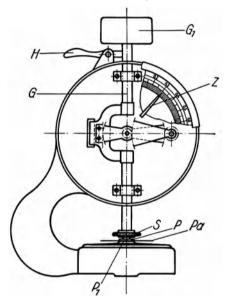
gesetzt wird, ist der Apparat mit einer Luftdruckbremse ausgerüstet. Die Fläche des Tasters beträgt 2 cm<sup>2</sup>.
