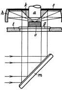
Abb. 95. Strahlengang bei Verwendung des Busch-Dunkel-feldkondensors für Auflicht.
