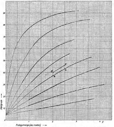
Abb. 152, Abhängigkeit der Mahlgrade "Schopper-Riegler" von der Probegutmenge.
