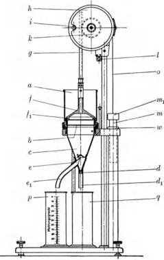
Abb. 149. Schoppers Mahlungsgradprüfer mit Hubvorrichtung.
