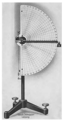
Abb. 50. Steifeprüfer nach Schacht.
