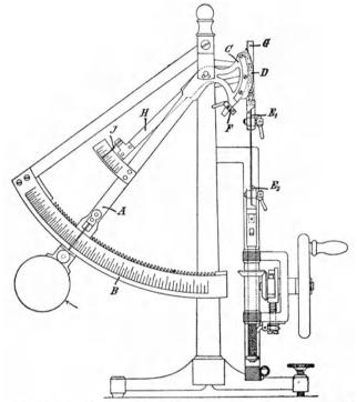
Abb. 21. Schoppers Festigkeitsprüfer für Papier mit Handantrieb.
