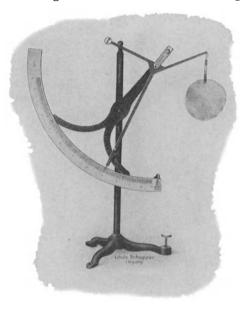
Abb. 151. Waage zur Gewichtsbestimmung des Stoffkuchens.
