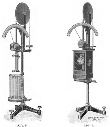
Abb. 6 u. 7. Fenchels Apparat zur Bestimmung der Paßfähigkeit von Papier.
