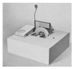
Abb. 52. Apparat zur Prüfung der Leimfestigkeit nach der "Curl"-Methode.
