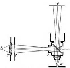
Abb. 96. Strahlengang bei Verwendung des Vertikalilluminators.
