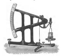
Abb. 137. Schoppers Aschenwaage.
