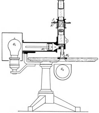
Abb. 77. Lichtdurchlässigkeitsprüfer nach Maximowitsch.
