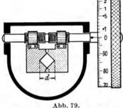
Mechanismus der quadratischen Blende mit Mikrometerschraube.
