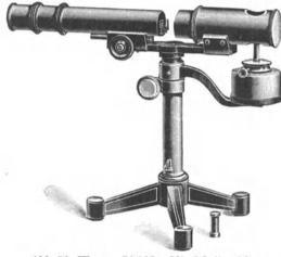
Abb. 76. Klemms Lichtdurchlässigkeitsprüfer der Firma Schopper.
