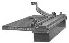
Abb. 19. Vorrichtung zum Schneiden der Streifen.
