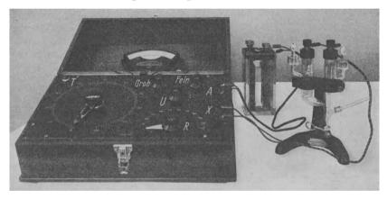
Abb. 144. Elektrometrische  $p_H$ -Meßeinrichtung nach Dr. Thrun und Dr. Tödt.
