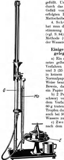
Abb. 68. Wasserdurchlässigkeitsprüfer für Gewebe und Papier.
