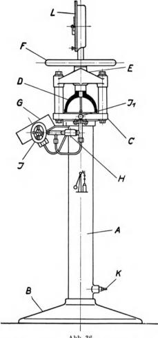
Abb. 36. Aufbau des Schopperschen Berstdruckprüfers.
