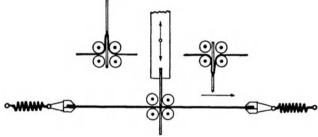
Abb. 42. Skizze zur Veranschaulichung der Wirkungsweise des Schopperschen Falzers.
