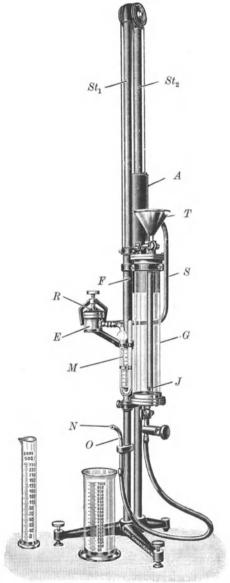
Abb. 74. Luftdurchlässigkeitsprüfer nach Schopper.
