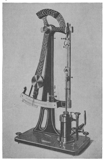
Abb. 24. Schoppers Festigkeitsprüfer für Pflanzen- und Tierhaare, Elementarfasern, Bastbündel usw.
