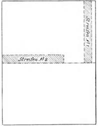
Abb. 18. Entnahme der Probestreifen.
