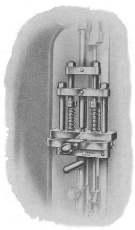
Abb. 154. Vorrichtung für Stanz- (Scher-) Versuche nach Dr. Humm.
