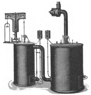
Abb. 9. Schoppers Trockenapparat für Zellstoff, Holzstoff usw. mit Vortrockner.
