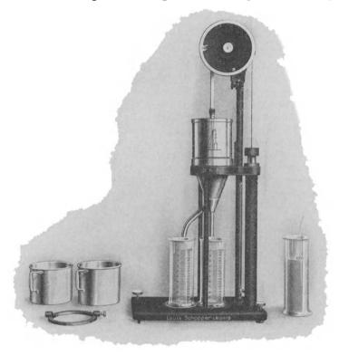
Abb. 148. Schoppers Mahlungsgradprüfer mit Hubvorrichtung.
