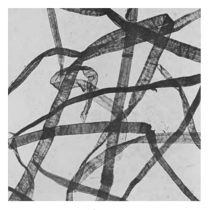
Abb. 133. Netzförmige Äderung auf Sulfitzellstoffasern.
