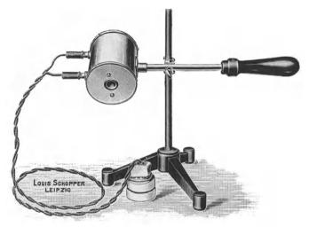
Abb. 141. Elektrische Veraschungsvorrichtung.
