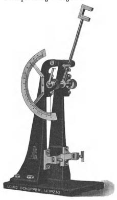
Abb. 28. Schoppers Pendelschlagwerk.
