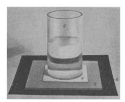
Abb. 70. Versuchsanordnung für die "Mattglas-Methode"
