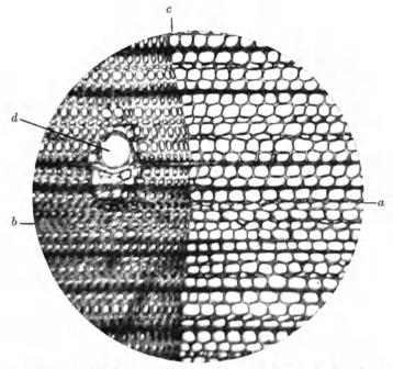
Abb. 105. Querschnitt von Kiefernholz (150fache Vergr.). a Frühholz; b Spätholz; c Jahresring; d Harzgang.
