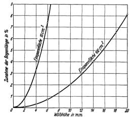
Abb. 38. Schaubild nach Dalén zur Ablesung der den Wölbhöhenwerten entsprechenden Zahlen für die absolute Dehnung.
