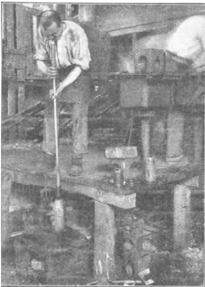
Abb. 103b. Einblasen einer Flasche in die eiserne Form.
