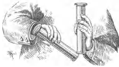
Abb. 35. Wasserstoff ist leichter als Luft.
