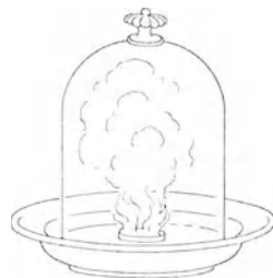
Abb. 71. Verbrennung von Phosphor.
