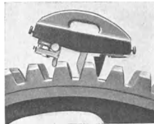
Abb. 137. Odontometer für große Räder.
