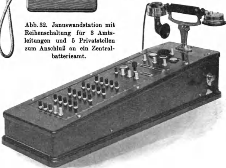
Abb. 33. Janustischstation für Reihenschaltung, mit 4 Amtsleitungen, deren eine vorgeschaltet, so daß das Amt direkt unter Umgehung der Hauszentrale gerufen werden kann, 4 Mithörtasten, einer Zentralklinke, 23 privaten Linienwähleranschlüssen und 2 Botenrufknöpfen.
