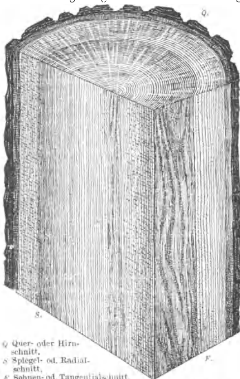
Abb. 37. Darstellung der drei Hauptschnittrichtungen.
