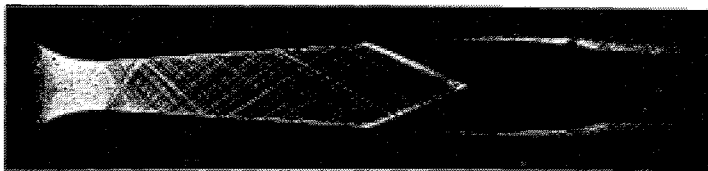
Abb. 98. Ausströmen von Luft mit Überschallgeschwindigkeit aus einer sich erweiternden Düse. Die MACHschen Linien beginnen hinter dem engsten Querschnitt.
