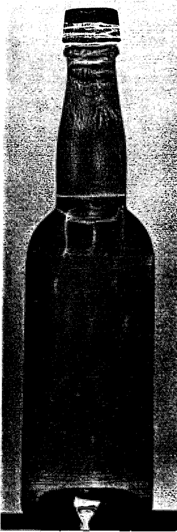
Abb. 43. Schattenbild einer guten Flasche, am Hals jedoch Störungen. (Aus H. JEBSEN-MARWEDEL: Glastechnische Fabrikationsfehler, Berlin: Springer 1936.)
