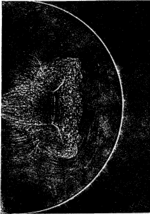
Abb. 91. Bevor das Geschoß den Lauf verläßt, muß die im Lauf befindliche Luft herausgedrückt werden. Infolge davon bilden sich vor der Mündung eine kugelförmige Knallwelle sowie Strömungserscheinungen aus. (Schattenaufnahme.)
