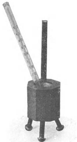
Abb. 27. Fürbringers Apparat zur Thermometrie des Harns.
