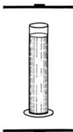
Abb. 69. Derselbe Elektrolyt erwärmt sich in Gefäßen von verschiedenem Durchmesser verschieden stark.
