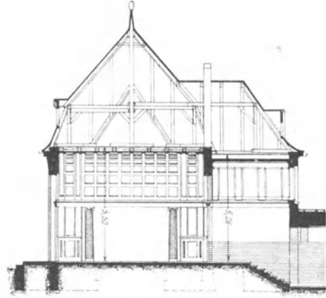
Abb. 31. Schnitt durch das Vorgebäude in Hermsdorf.
