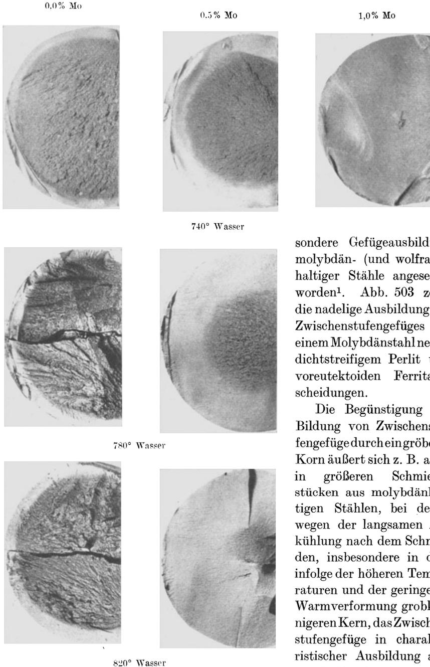
Abb. 504. Wirkung von Molybdän auf die Durchhärtung bei Stählen mit 0,9% C. [Nach E. Houdremont u. H. Schrader: Techn. Mitt. Krupp, Forschungsber. Bd. 2 (1939) S. 23/46.]
