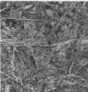
Abb. 34. Zementitausscheidungen in Widmannstättenscher Anordnung. (Stahl mit 1,72% C.)
