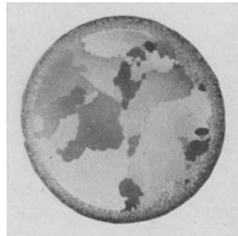
Abb. 8. Starke Grobkornbildung bei längerer Glühung von Carbonyleisen durch 60stündige Zementation bei 850°. [Nach F. Duftschmidt u. E. Houdremont: Stahl u. Eisen Bd. 51 (1931) S. 1613/16.]
