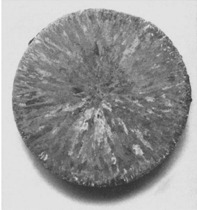
Abb. 444. Transkristallisationserscheinungen bei V 2 A - Gußblöcken. V = 1:1
